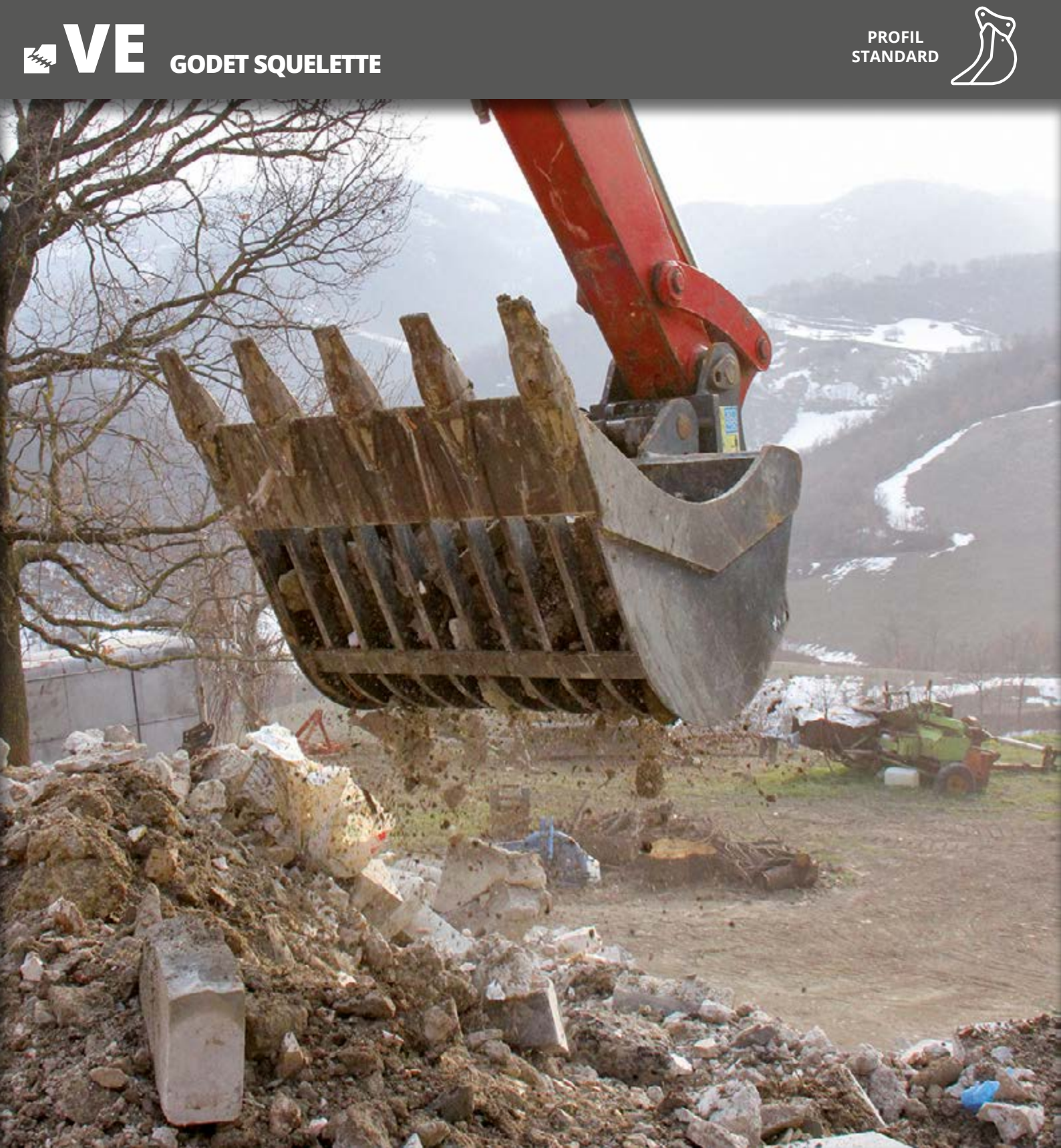
LE GODET SQUELETTE EST CONÇU POUR LA SÉLECTION DES PIERRES ET DES MATÉRIAUX INERTES. LA DISTANCE ENTRE LES MAILLES DÉTERMINE LA TAILLE DES MATÉRIAUX SÉLECTIONNÉS.
