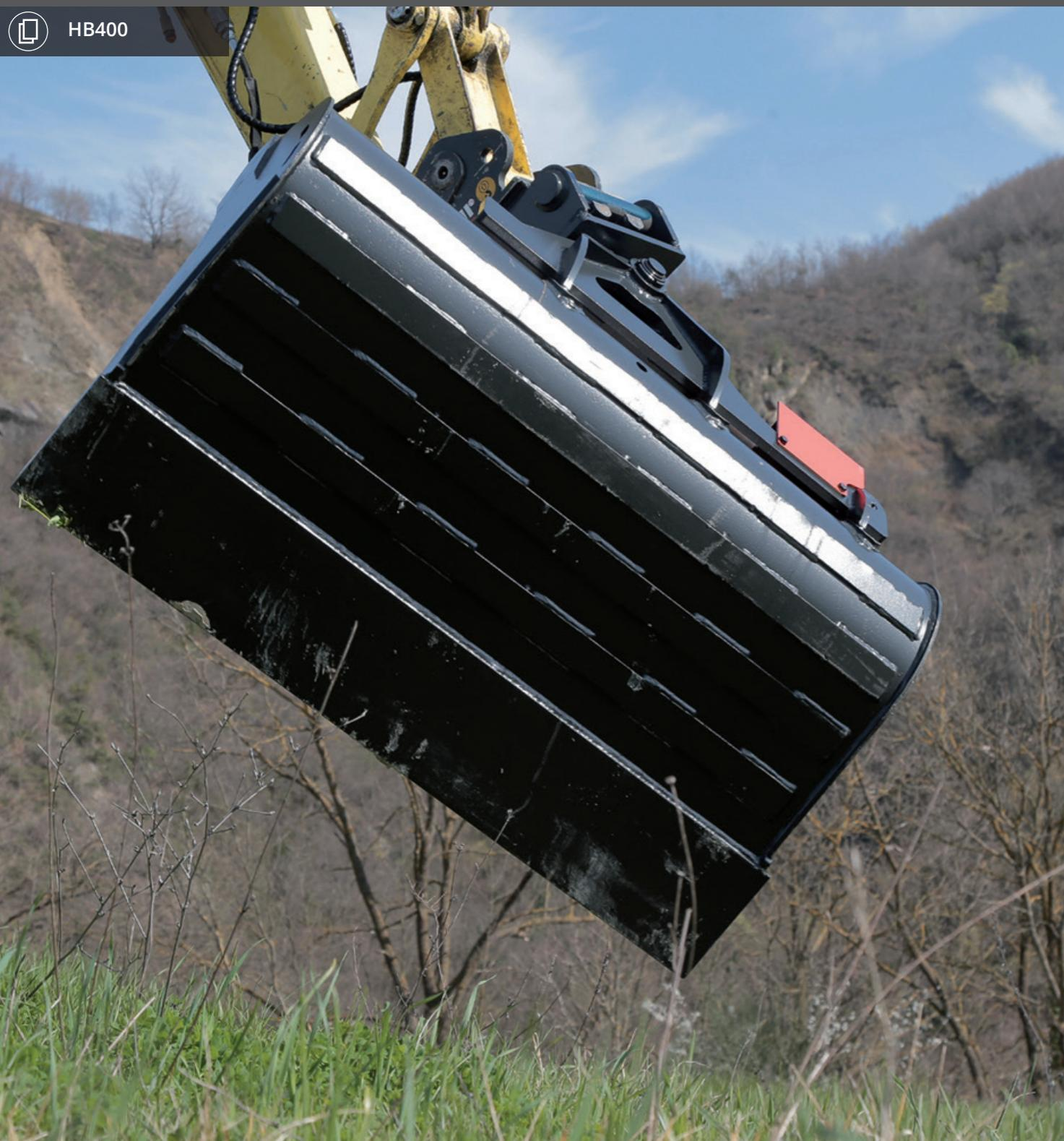
LOS REFUERZOS DE HB400 EN LOS PUNTOS MÁS SUJETOS A DESGASTE, LAS CUCHILLAS LATERALES REALIZADAS EN FUNDICIÓN Y UNA HOJA INFERIOR REVERSIBLE EMPERNADA HACEN QUE ESTE CAZO SEA IDEAL PARA TRABAJAR EN TERRENOS SUMAMENTE ABRASIVOS. MUY ADECUADA PARA TRABAJOS DE TERMINACIÓN Y NIVELACIÓN. SU SISTEMA OSCILANTE PERMITE INCLINAR EL CAJÓN 45° DE CADA LADO; LA VÁLVULA DE BLOQUEO, INCLUIDA EN LA VERSIÓN ESTÁNDAR, PERMITE MANTENER EL GRADO DE INCLINACIÓN.
