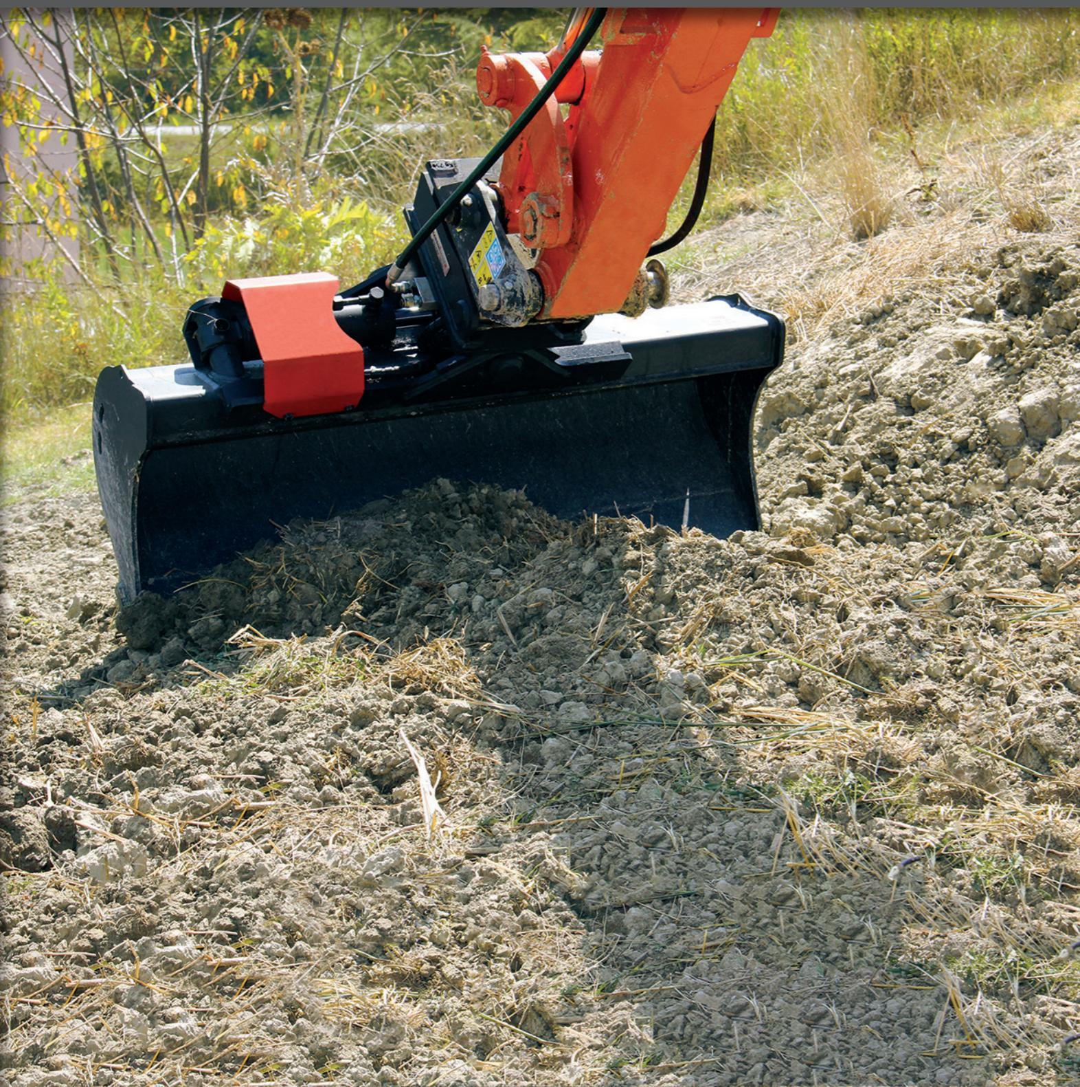
IDEAL ZUM EINEBNEN UND FÜR FEINARBEITEN. BEIDSEITIG 45° SCHWENBAR UND DANK SERIENMÄSSIGEM BLOCKVENTIL FESTSTELLBAR.
