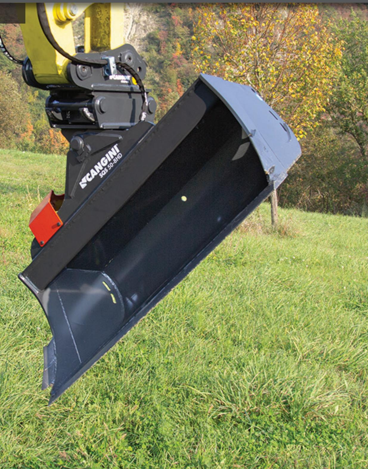
SON MOUVEMENT PERMET D'INCLINER LE GODET DE 45° SUR LES DEUX CÔTÉS. SA FORME ALLONGÉE EMPÈCHE QUE LE TERRAIN ADHÈRE AUX PAROIS LATÉRALES DU GODET ET FACILITE LE DÉCHARGEMENT DES MATERIAUX ARGILEUX ET MOUILLÉS. INDUIT POUR L'ENTRETIEN ET LE NIVELAGE DE ROUTES, FOSSÉS ET TALUS. CE GODET A ÉTÉ RENFORCÉ DANS TOUTES LES PARTIES LES PLUS EXPOSÉES À L'USURE. LA LAME, LES TRANCHANTS ET PLAQUES LATÉRALES ET LES BANDES POSTÉRIEURES SONT RÉALISÉES EN HB400.
