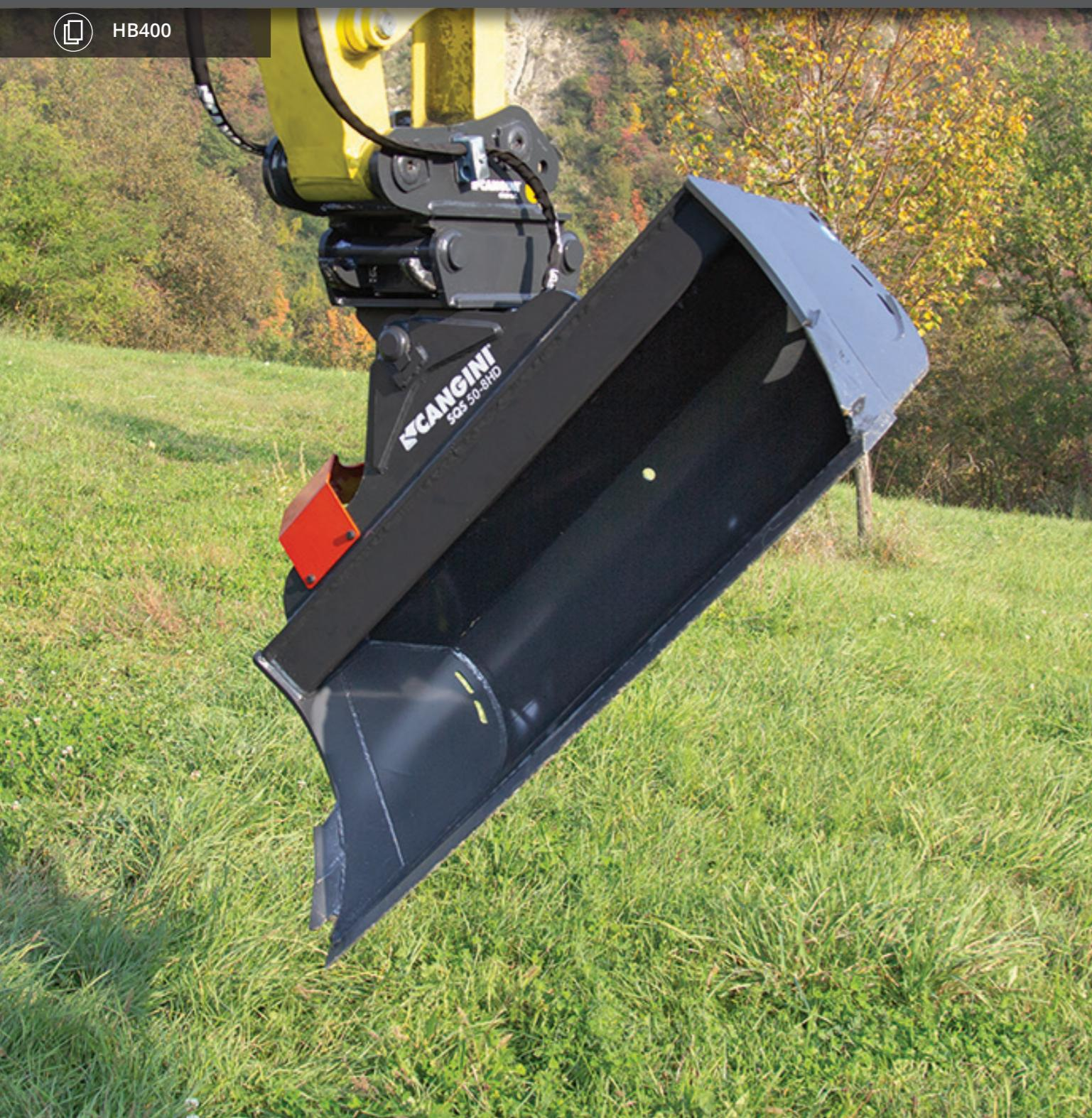
DIESER HYDRAULISCHE GRABENRÄUMLÖFFEL HAT EINEN SCHWENKWINKEL VON 45°, RECHTS WIE LINKS. SEIN LANGGEZOGENES PROFIL VERHINDERT, DASS FEUCHTES ODER HUMOSES ERDREICH AN DEN SEITENWÄNDEN HAFTET. DIE SEITEN DES LÖFFELS VERJÜNGEN SICH UM 8°. DADURCH IST DIESER LÖFFEL IDEAL GEEIGNET FÜR DIE REINIGUNG VON GRÄBEN, STRASSEN UND BÖSCHUNGEN. ER IST MIT VERSTÄRKUNGEN AUS HB 400 IN DEN HAUPTVERSCHLEISSSTELLEN.
