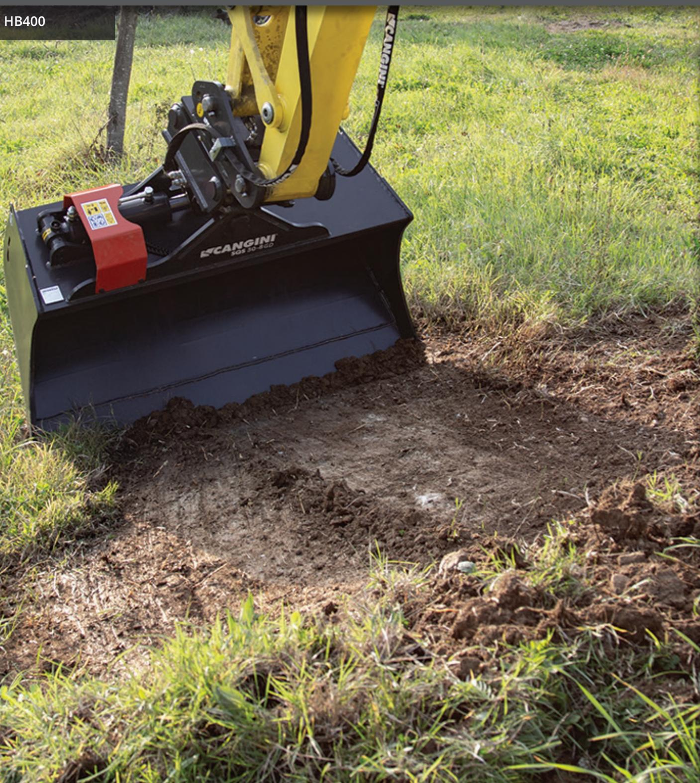
DIESER HYDRAULISCHE GRABENRÄUMLÖFFEL HAT EINEN SCHWENKWINKEL VON 45°, RECHTS WIE LINKS. SEIN LANGGEZOGENES PROFIL VERHINDERT, DASS FEUCHTES ODER HUMOSES ERDREICH AN DEN SEITENWÄNDEN HAFTET. DIE SEITEN DES LÖFFELS VERJÜNGEN SICH UM 8°. DADURCH IST DIESER LÖFFEL IDEAL GEEIGNET FÜR REINIGUNG VON GRÄBEN, STRASSEN UND BÖSCHUNGEN. SCHNEIDE AUS HB400 FÜR HÖHERE VERSCHLEISSFESTIGKEIT.
