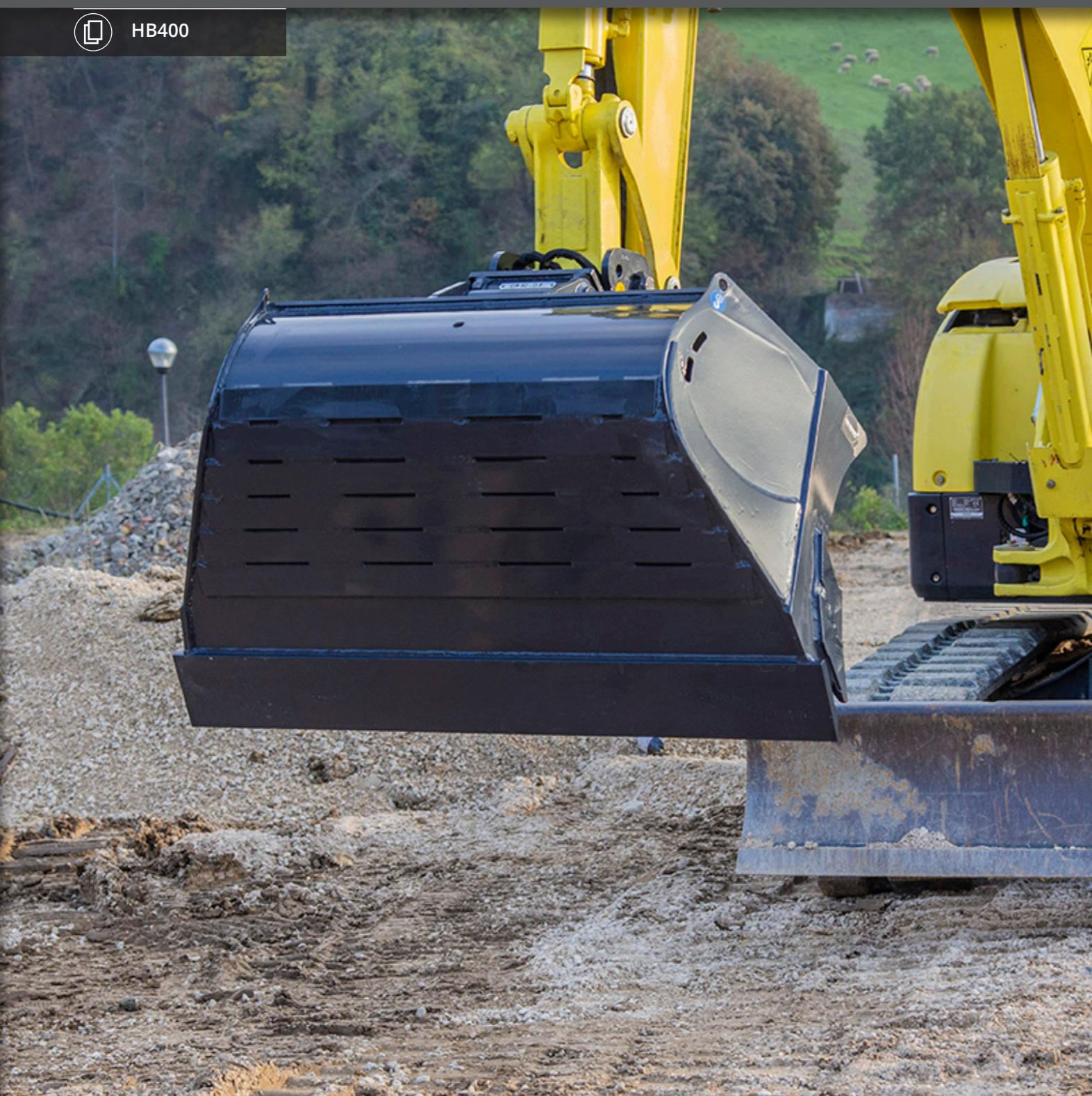
AVEC SA FORME ÉVASÉE À 25°, EST ADAPTÉ À L'ACCOPLEMENT AVEC LE SYSTÈME ROTOTWIST. L'ARRIÈRE, EN FORME CONIQUE À 8°, PERMET DE FAIRE TOURNER LE GODET EN LE MAINTENANT À L'INTÉRIEUR DU TERRACEMENT SANS ABÎMER CE DERNIER. CE GODET A ÉTÉ RENFORCÉ DANS TOUTES LES PARTIES LES PLUS EXPOSÉES À L'USURE. LA LAME, LES TRANCHANTS ET PLAQUES LATÉRALES ET LES BANDES POSTÉRIEURES SONT RÉALISÉES EN HB400.
