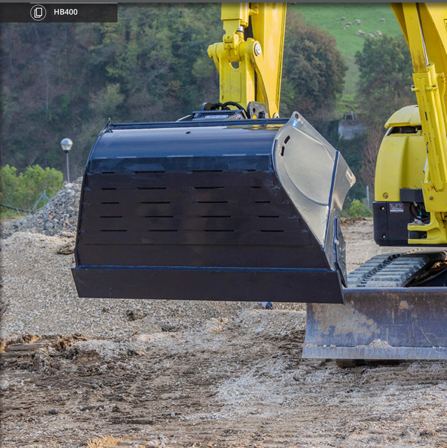
DIESER STARRE LÖFFEL IST IN DEN VERSCHLEISSEBENEN VERSTÄRKT. ER VERJÜNGT SICH IN ZWEI STUFEN. IM OBEREN BEREICH IST ER UM 25° SCHMALER, UND DAHER IDEAL GEEIGNET FÜR DEN EINSATZ IN VERBINDUNG MIT EINEM ROTOTWIST. AN DER UNTEREN RÜCKSEITE WIRD UM 8° SCHMALER. DIES ERMÖGLICHT DAS DREHEN DER SCHAUFEL IN DER GRUBE OHNE DIE WÄNDE ZU BESCHÄDIGEN. ER IST MIT VERSTÄRKUNGEN AUS HB 400 IN DEN HAUPTVERSCHLEISSSTELLEN.
