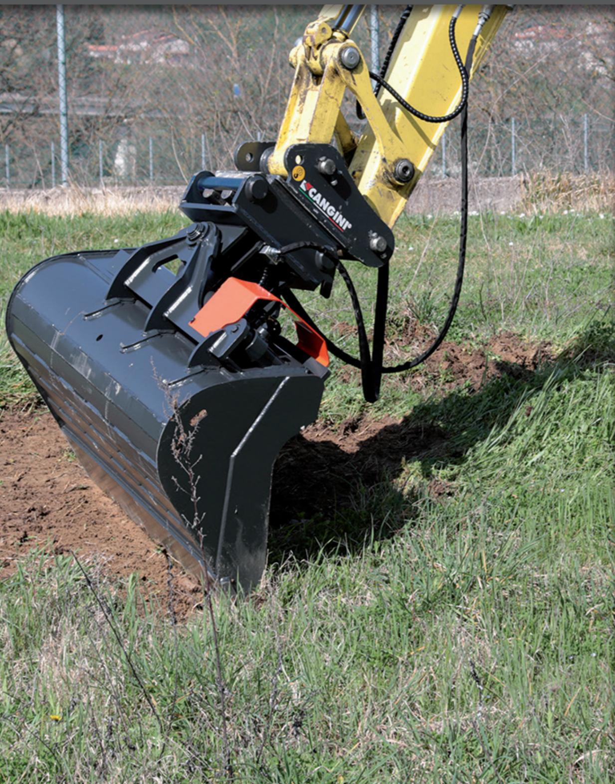
PARTICOLARMENTE ADATTA PER LAVORI DI FINITURA E LIVELLATURA. IL SUO SISTEMA OSCILLANTE CONSENTE DI INCLINARE LA VASCA DI 45° PER LATO; LA VALVOLA DI BLOCCO, MONTATA DI SERIE, NE MANTIENE COSTANTE LA POSIZIONE. LA SUA FORMA ALLUNGATA EVITA CHE IL TERRENO ADERISCA ALLE PARETI LATERALI DELLA BENNA AGEVOLANDO LO SCARICO DI MATERIALI ARGILLOSI E BAGNATI. PARTICOLARMENTE INDICATA PER LA PULIZIA E IL LIVELLAMENTO DI STRADE, FOSSATI E SCARPATE. LA BENNA NETHERLANDS È DOTATA DI LAMA IN HB400.
