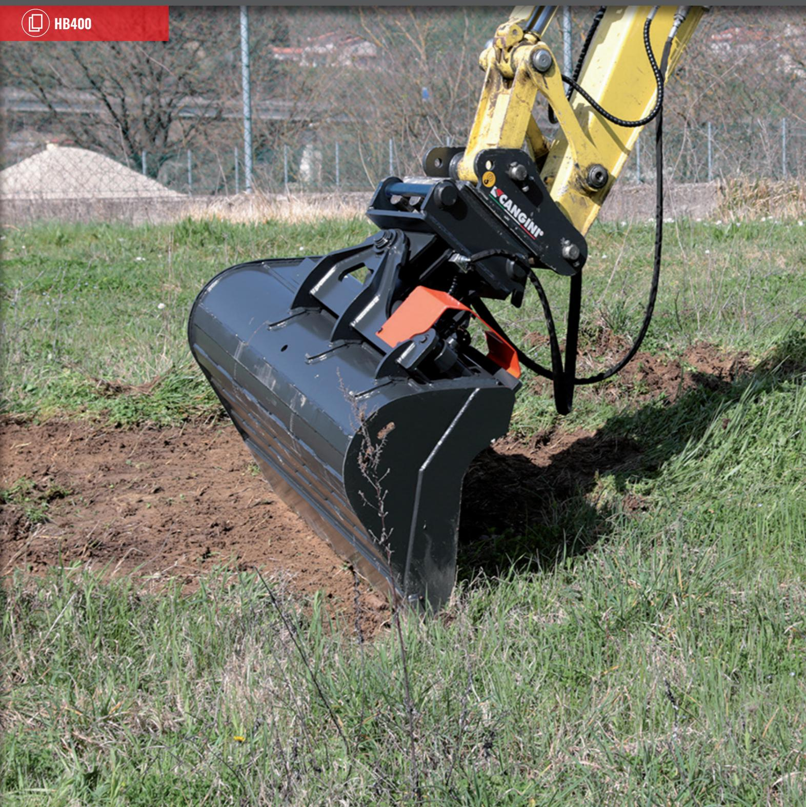
MUY ADECUADO PARA TRABAJOS DE TERMINACIÓN Y NIVELACIÓN. SU SISTEMA OSCILANTE PERMITE INCLINAR EL CAJÓN 45° DE CADA LADO; LA VÁLVULA DE BLOQUEO, INCLUIDA DE SERIE, PERMITE MANTENER LA POSICIÓN. SU FORMA ALARGADA HACE QUE LA TIERRA NO SE ADHIERA A LOS COSTADOS, FACILITANDO LA DESCARGA DE MATERIALES ARCILLOSOS Y HÚMEDOS. SUMAMENTE INDICADO PARA LA LIMPIEZA Y LA NIVELACIÓN DE CARRETERAS, ZANJAS Y ESCARPADAS. EL CAZO NETHERLANDS TIENE UNA HOJA DE HB400.
