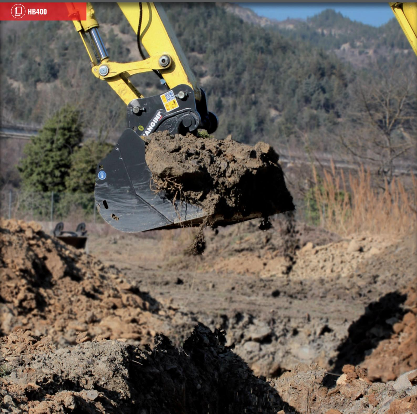
SA FORME ALLONGÉE PERMET DE DÉCHARGEMENT DE MATÉRIAUX ARGILEUX ET MOUILLÉS. UTILISÉ POUR L'ENTRETIEN ET LE NIVELAGE DE ROUTES, FOSSÉS ET TALUS. LAME EN HB400.
