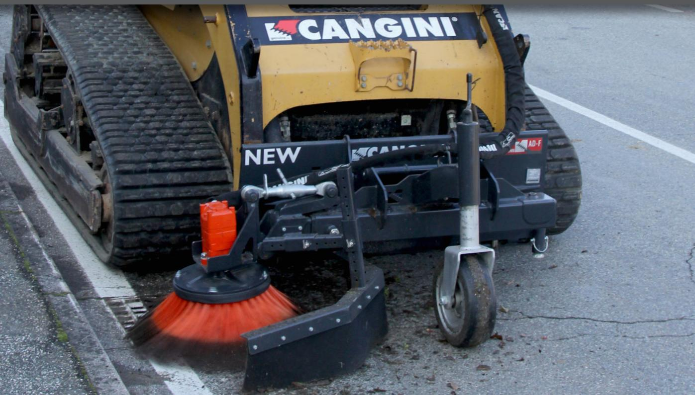
LA SPAZZOLA PER ATTACCO FRONTALE PUÒ ESSERE FACILMENTE MONTATA SIA A DESTRA CHE A SINISTRA, IN MODO DA POTER PULIRE ENTRAMBI I LATI DELLA STRADA. SNODO REGOLABILE E FLOTTANTE LE PERMETTONO DI SEGUIRE L'ANDAMENTO DELLA SUPERFICIE DA PULIRE.
