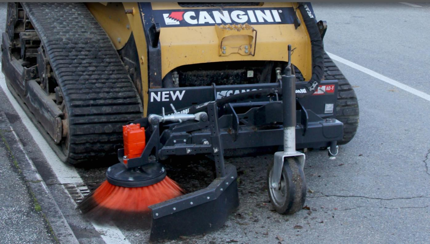
LA BROSSE FRONTALE PEUT ÊTRE FACILEMENT MONTÉE À DROITE ET À GAUCHE, CE QUI VOUS PERMET DE NETTOYER LES DEUX CÔTÉS DE LA ROUTE. LE JOINT ET LE FLOTTEUR LUI PERMETTENT DE SUIVRE LE COURS DU TERRAIN.
