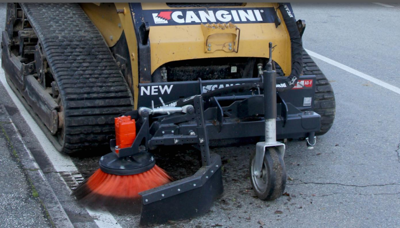
EL CEPILLO FRONTAL PUEDE SER FACILMENTE MONTADO TANTO A LA DERECHA COMO A LA IZQUIERDA, PARA PODER LIMPIAR LOS DOS LADOS DE LA CARRETERA. SISTEMA FLOTANTE Y DE ARTICULACIÓN PERMITEN SEGUIR LA TENDENCIA DEL TERRENO.
