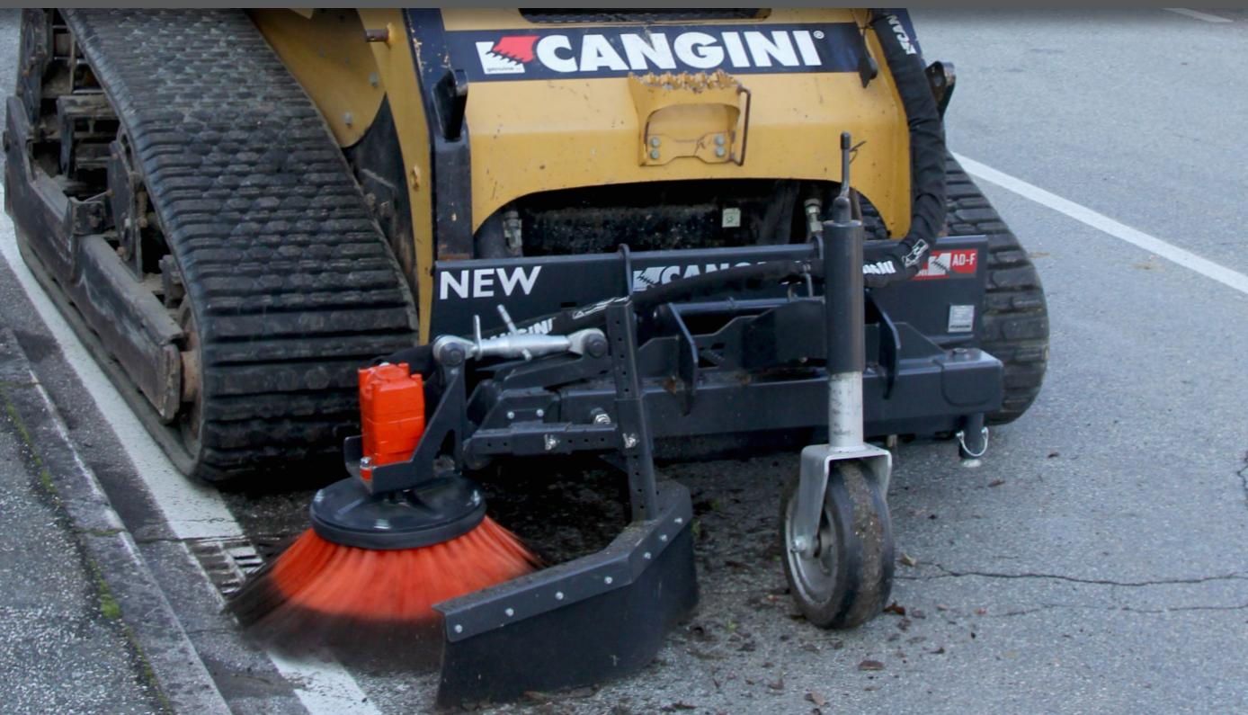
DIE FRONTANBAUBÜRSTE IST LEICHT SOWOHL RECHTS ALS AUCH LINKS MONTIERBAR, SO DASS MAN BEIDE STRASSENSEITEN LEICHT REINIGEN KANN.
