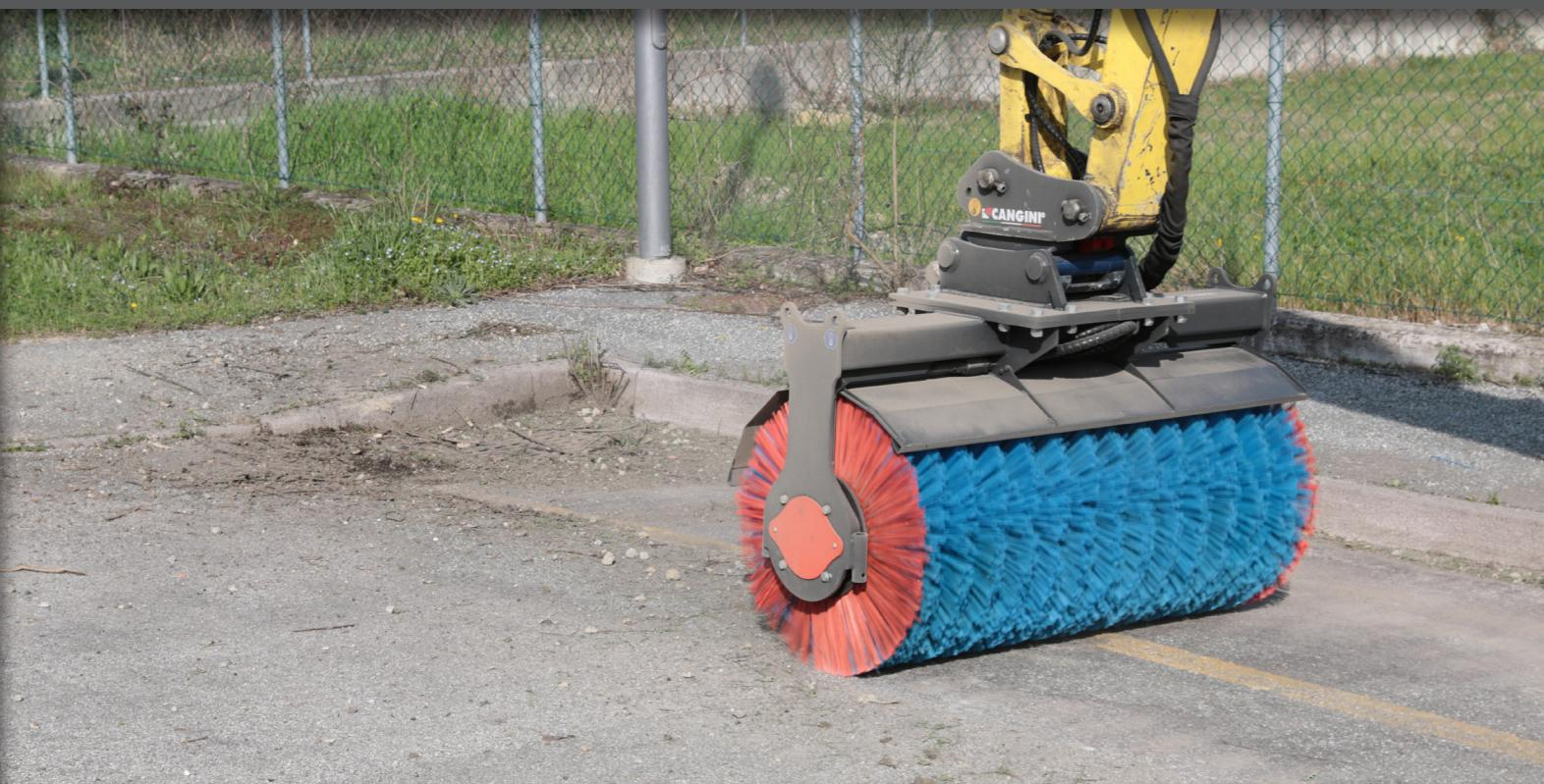
BALAYEUSE POUR PELLETEUSES, INDIQUEE POUR LE NETTOYAGE DE SURFACES HORIZONTALES ET VERTICALES ET D'ESPACES QUE LES MACHINES FRONTALES NE PEUVENT PAS REJOINDRE. EQUIPÉE DE PATINS STABILISATEURS POUR SAUVEGARDER LES BROSSES PENDANT LE POSITIONNEMENT DE L'OUTIL. VANNES RÉGULATRICES DE FLUX ET DE PRESSION DE SÉRIE. LE MOTEUR À TRANSMISSION DIRECTE AVEC DISTRIBUTEUR À DISQUES A ÉTÉ PLACÉ À L'INTÉRIEUR DE L'ARBRE DES BROSSES POUR REDUIRE L'ENCOMBREMENT OPERATIONNEL DE LA BALAYEUSE.
