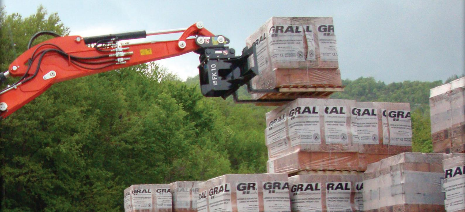
ESTA CONFIGURACIÓN ES COMPATIBLE CON LAS EXCAVADORAS PARA LA MANIPULACIÓN DE CARGAS EN ZONAS DE DIFÍCIL ACCESO CON OTROS MEDIOS. ES NECESARIO COMPROBAR DE TODOS MODOS QUE LA EXCAVADORA SEA APTA PARA LA ELEVACIÓN DE CONFORMIDAD CON LA DIRECTIVA MÁQUINAS.
