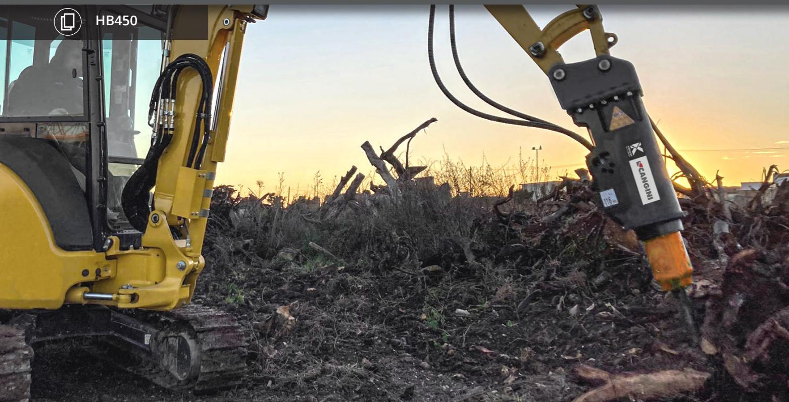
LE MARTEAU-PIQUEUR HYDRAULIQUE SÉRIE C.B. EST DISPONIBLE EN 9 MODÈLES POUR DES PELLES D'UN POIDS OPÉRATIONNEL DE 0,5 À 12,5 TONNES. SA STRUCTURE EST CONSTITUÉE D'UNE ENVELOPPE CONÇUE POUR MINIMISER LES NIVEAUX SONORES ÉMIS PAR LE MARTEAU. LE SYSTÈME EST DÉVELOPPÉ POUR RÉCUPÉRER DE L'ÉNERGIE INERTIELLE DE L'AZOTE, CE QUI PERMET D'AUGMENTER LA PUISSANCE. LA CONCEPTION DU PRODUIT FAVORISE UNE MEILLEURE VISIBILITÉ PENDANT LE FONCTIONNEMENT.
