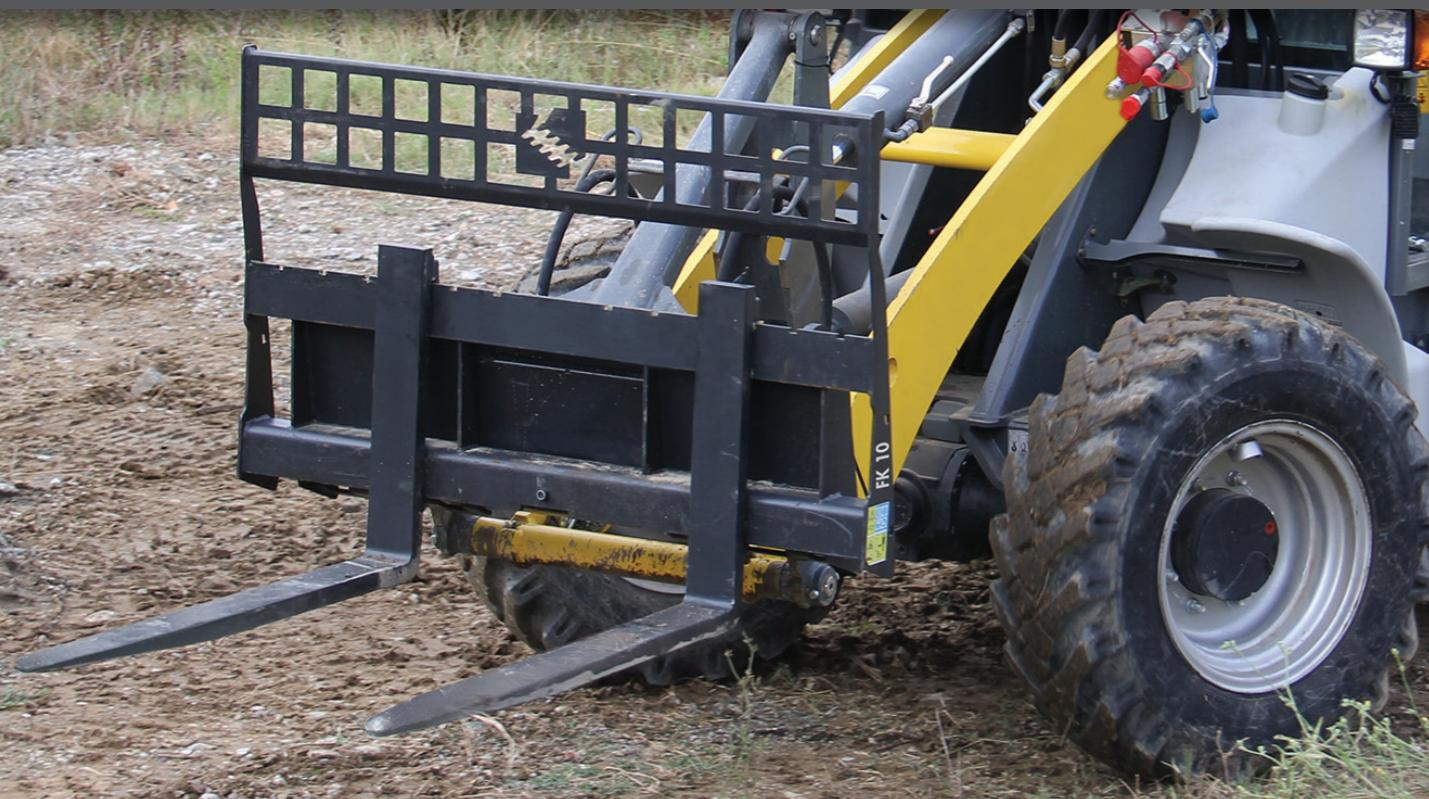
FORCA PALLET APPLICABILE SU SKID LOADER, PALE GOMMATE, TELESCOPICI E TERNE. DOTATA DI UNA PROTEZIONE DI SICUREZZA CONTRO IL RIBALTOAMENTO DI CARICHI DURANTE L'UTILIZZO, SOLO NELLE FORCHE APPLICATE A SKID LOADER E MINI SKID LOADER.
