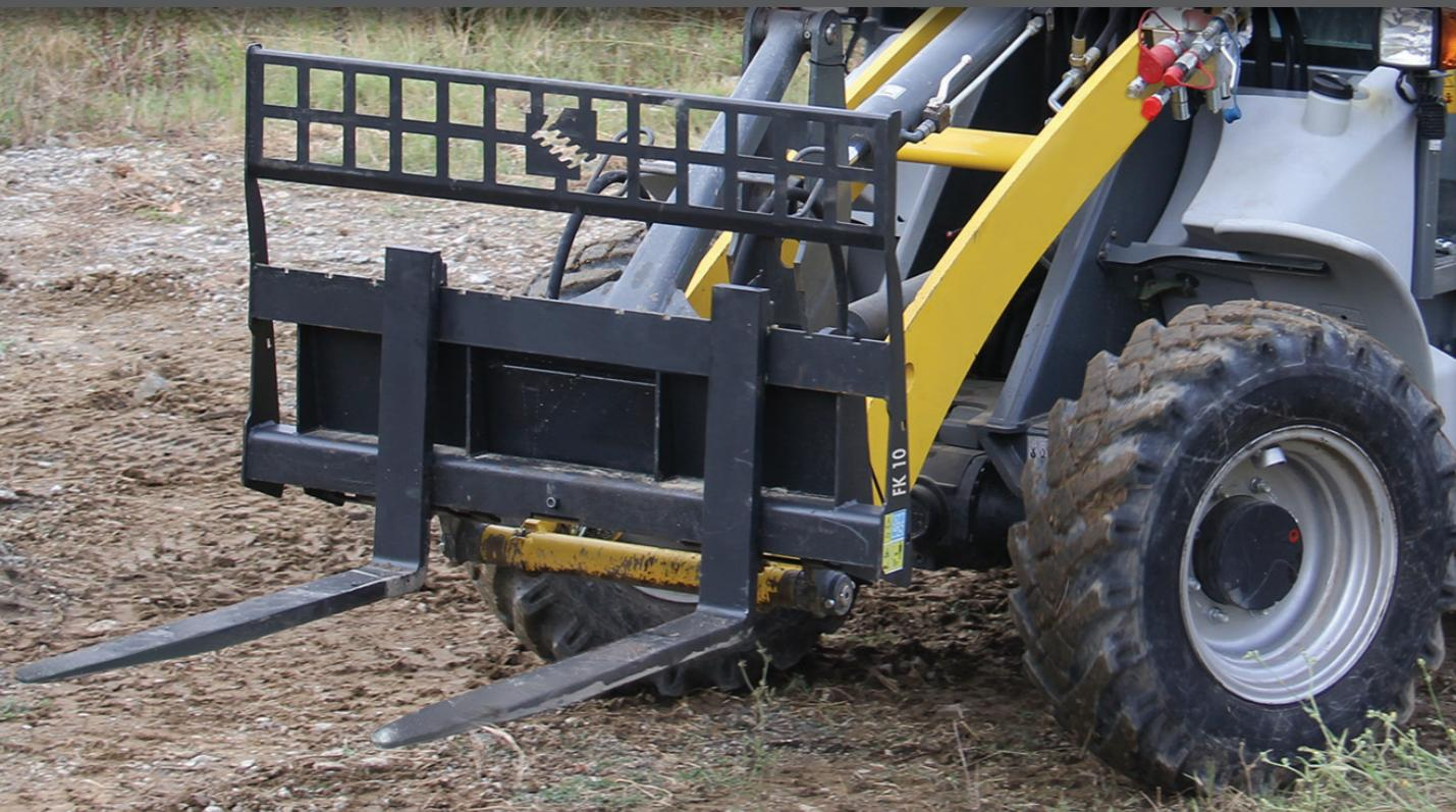
HORCA DE PALETAS COMPATIBLE CON MINICARGADORAS, PALAS SOBRE RUEDAS, CARGADORAS TELESCÓPICAS Y RETROCARGADORAS. DOTADA DE UNA PROTECCIÓN DE SEGURIDAD CONTRA EL VUELCO DE LA CARGA DURANTE EL USO, SOLO EN LAS HORQUILLAS APLICADAS A MINICARGADORAS Y MINICARGADORAS COMPACTAS.
