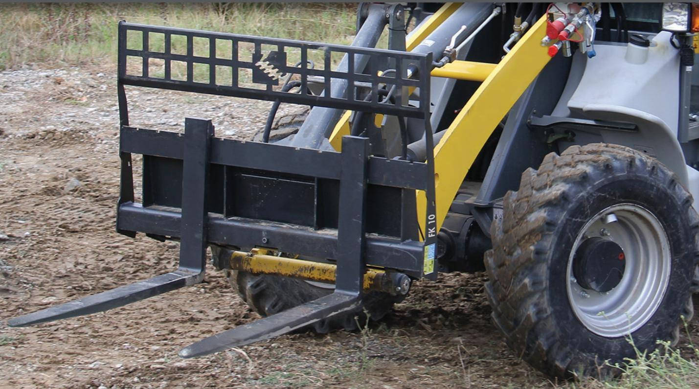
PALETTENGABEL ZUM ANBAU AN SKIDLOADER, RAD-, TELESKOP- UND BAGGERLADER. EIN KLAPPBARES SCHUTZGITTER SICHERT DIE LADUNG WÄHREND DER FAHRT, NUR BEI GABELN, DIE AN KOMPAKTLADERN UND MINIKOMPAKTLADERN ANGEBRACHT SIND.
