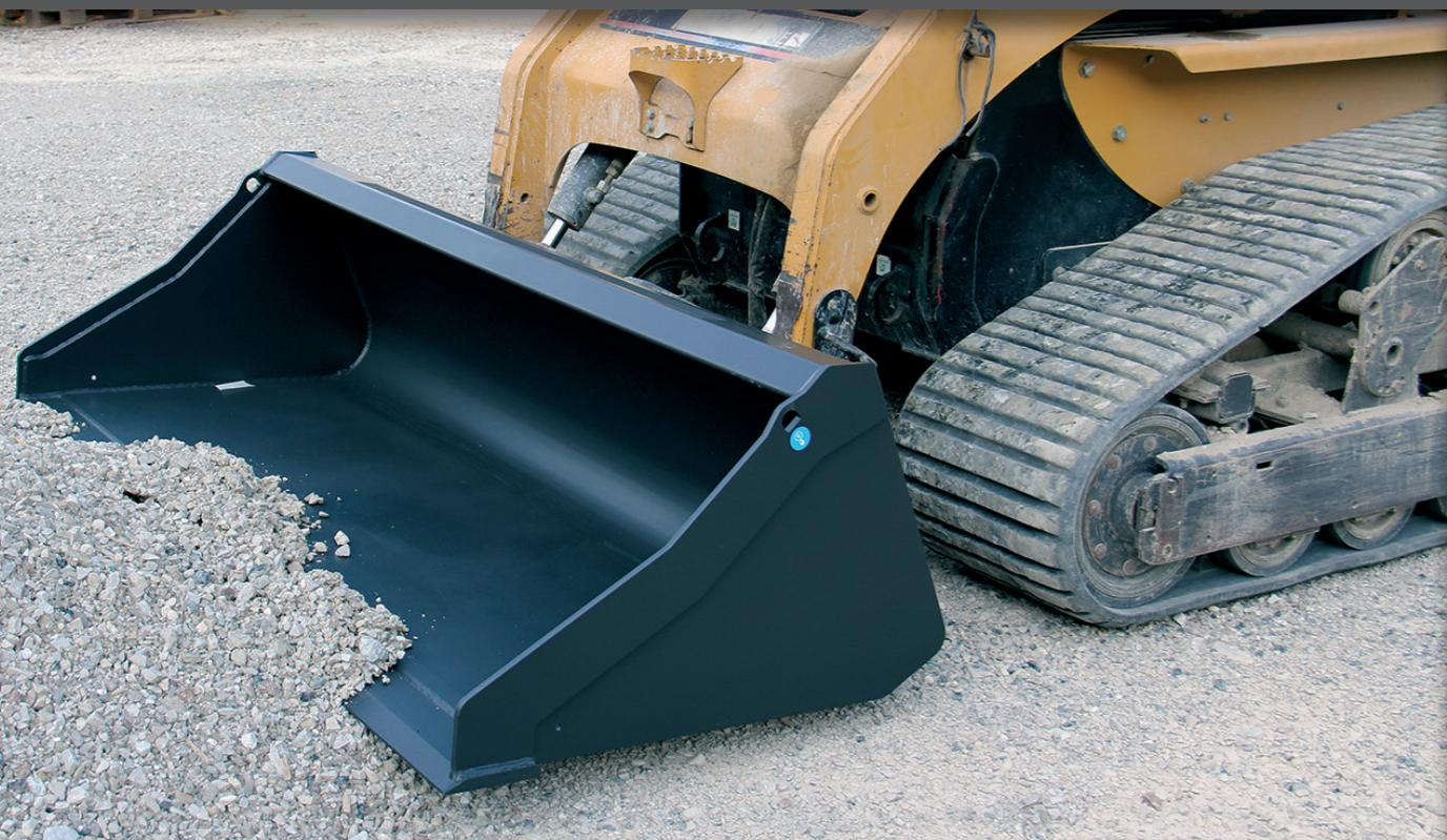
LE GODET AVANT POUR SKID OFFRE UNE CAPACITÉ DE CHARGEMENT OPTIMALE GRÂCE À SON PROFIL CONÇU POUR UNE MEILLEURE SURFACE DE CONTACT AVEC LE SOL. SA FORME PERMET DE CONSERVER LES MATERIAUX FINS ET GRANULEUX À L'INTÉRIEUR, ÉVITANT AINSI LES PERTES DE MATERIAU PENDANT LE TRANSPORT. C'EST LE GODET IDÉAL POUR LE CHARGEMENT ET LE DÉCHARGEMENT DE MATERIAUX DIVERS.
