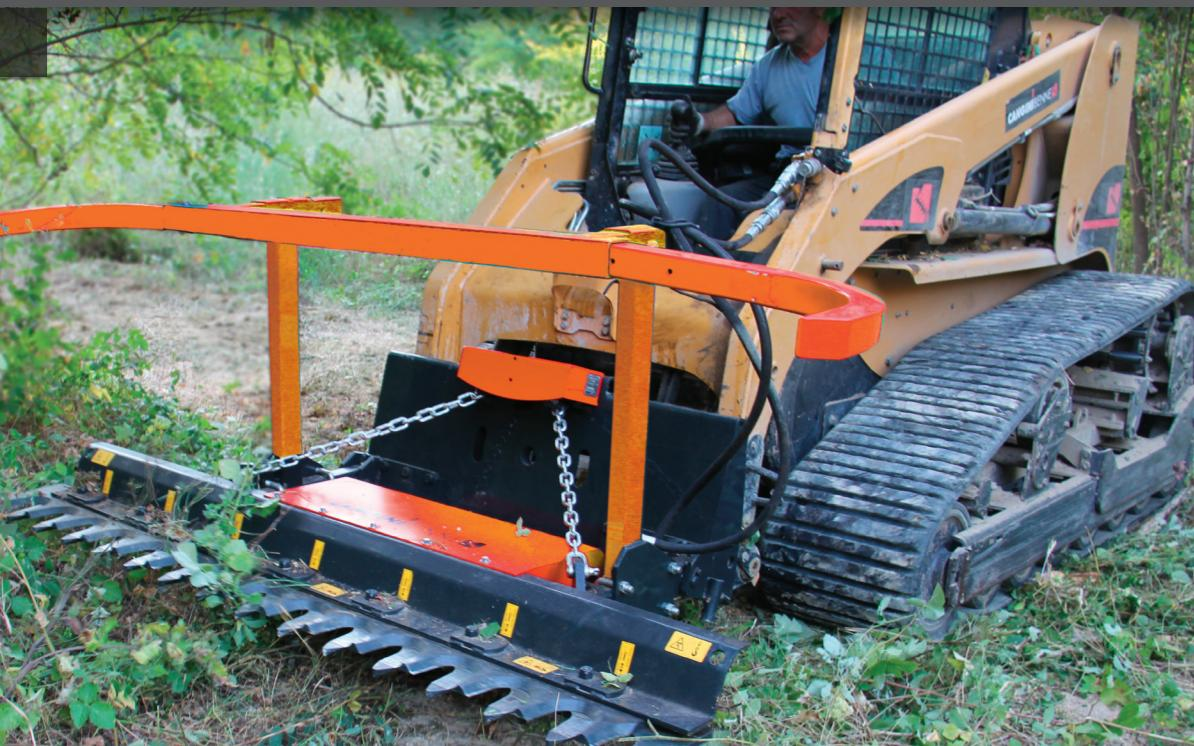
CETTE BARRE SHARP-CUT D'ÉLAGAGE EST ADAPTÉE À LA TAILLE DE BRANCHES JUSQU'À 100 MM. ELLE N'ABIME PAS LA PLANTE EN EXÉCUTANT UNE TAILLE NETTE ET PRÉCISE QUI NE DÉCHIRE PAS LA BRANCHE. SES LAMES SONT EN HB450, CE QUI ASSURE RÉSISTANCE ET DURETÉ DANS LE TEMPS.
