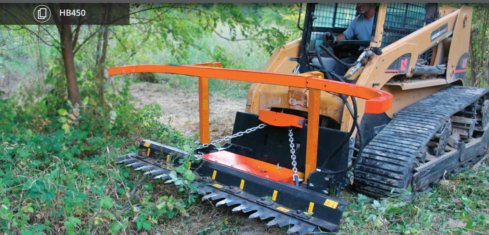
EL CABEZAL CORTADOR DE RAMAS SHARP-CUT SE UTILIZA PARA LA PODA DE RAMAS DE 0 A 100 MM. CON SU CORTE NETO Y PRECISO, NO ARRUINA LA PLANTA NI ARRANCA LA RAMA. LAS CUCHILLAS DE LAS SIERRAS SON DE HB450, QUE GARANTIZA UNA GRAN DURACIÓN Y RESISTENCIA.
