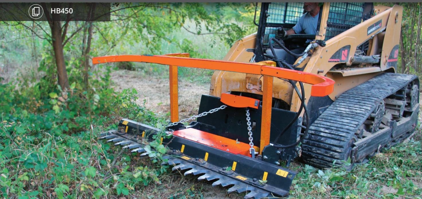
DIE ASTSCHEREN GIBT ES IN DEN ZWEI SCHNITTWEITEN VON 50 UND 100 MM. DIE SCHNEIDEN AUS DEM VERSCHLEISSFESTEN STAHL HB 450 SICHERN LANGE ZEIT EINEN SAUBEREN SCHNITT. DIE Gleitflächen aus BRONZE sind ROBUST UND EFFIZIENT.
