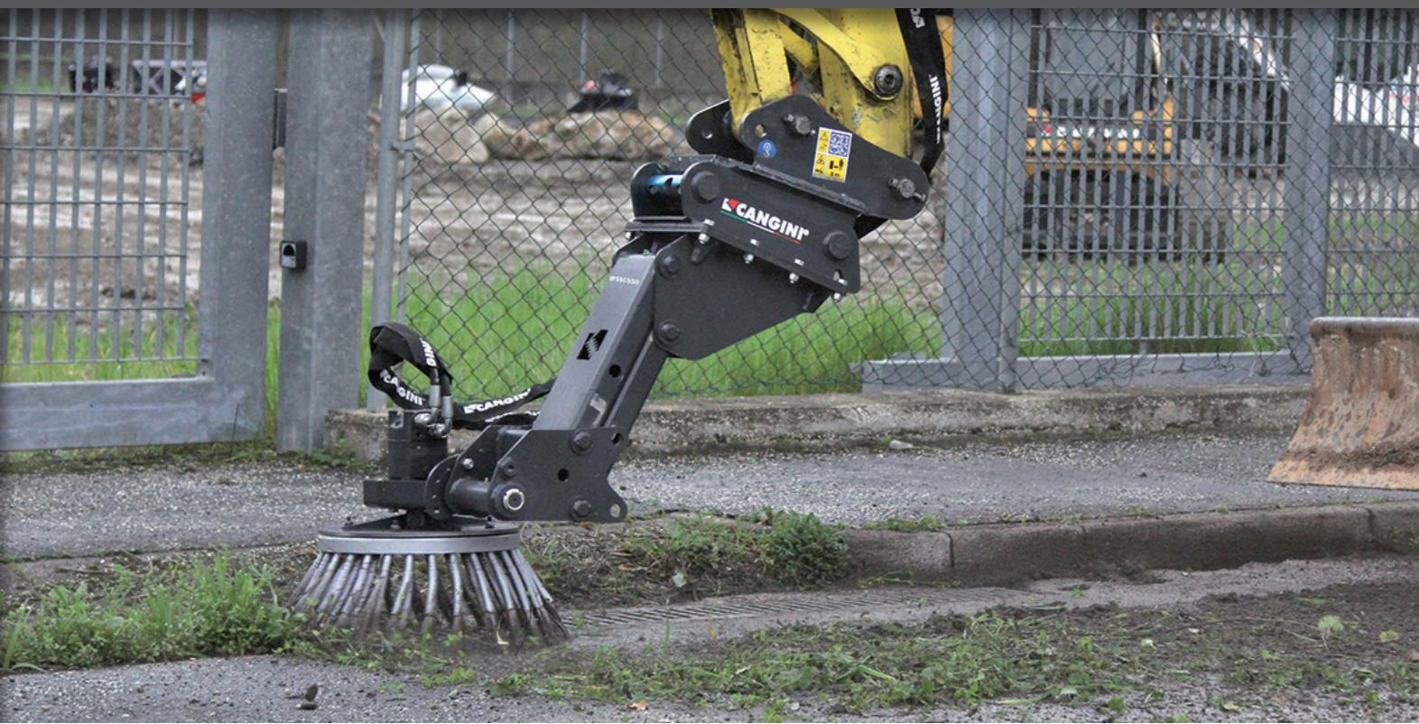
CETTE BROSSE, POUR PELLETEUSE, DOTÉE D'ÉLÉMENTS EN ACIER, EST ADAPTÉE AU NETTOYAGE DE BORDURES, TROTTOIRS ET ACCOTEMENTS DES ROUES. LE SYSTÈME FLOTTANT ET LE JOINT, DE SÉRIE, PERMETTENT À LA BROSSE DE SUIVRE LES SURFACES. LES DEUX SYSTÈMES D'ARTICULATION PEUVENT ÊTRE BLOQUÉS EN POSITION FIXE SELON LES EXIGENCES DE L'UTILISATEUR. EN ADOPTANT LA BROSSE EN PPL ON PEUT TRAITER LES SURFACES LES PLUS DÉLICATES OÙ LE DÉSHERBAGE N'EST PAS NÉCESSAIRE.
