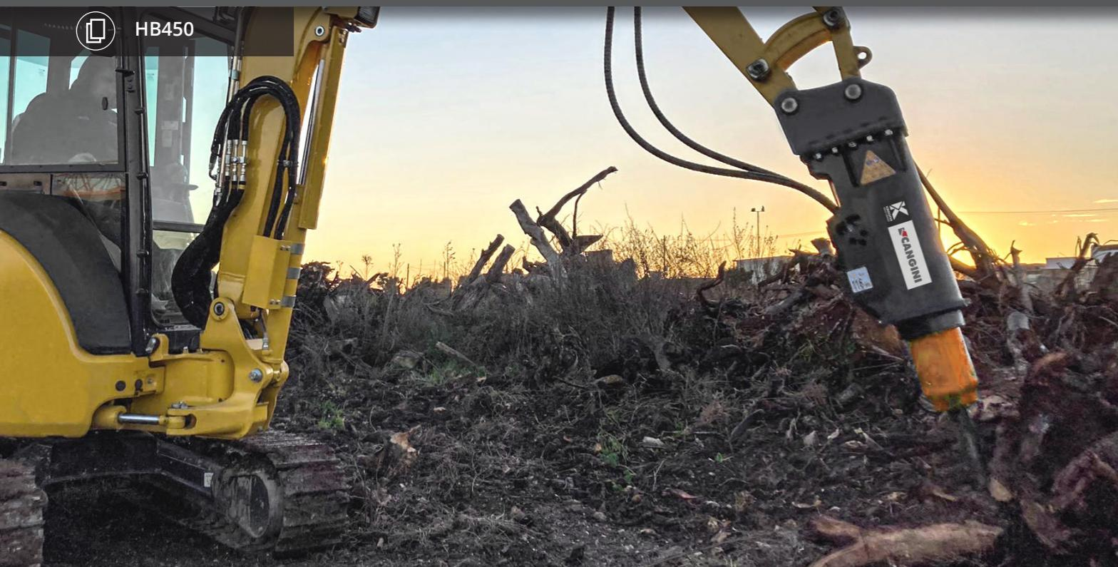
IL MARTELLO DEMOLITORE IDRAULICO SERIE C.B È DISPONIBILE IN 9 MODELLI PER ESCAVATORI CON PESO OPERATIVO DA 0,5 A 12,5 TON. LA SUA STRUTTURA È REALIZZATA CON SCOCCA A INVOLUCRO PENSATA PER RIDURRE AL MINIMO I LIVELLI SONORI EMESSI DAL MARTELLO. IL SISTEMA È SVILUPPATO PER RECUPERARE ENERGIA INERZIALE DELL'AZOTO CON CONSEGUENTE AUMENTO DI POTENZA. IL DESIGN DEL PRODOTTO FAVORISCE UNA MIGLIORE VISIBILITÀ DURANTE LE FASI OPERATIVE.
