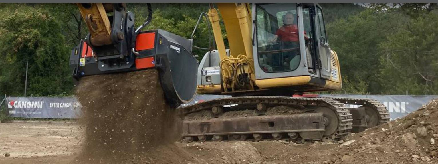
LA BENNA VAGLIATRICE VRC È ADATTA ALLA SELEZIONE DI DIVERSI MATERIALI DERIVATI DA DEMOLIZIONI O SCAVI. LO SPESORE DEL MATERIALE DA VAGLIARE VA DA  $\approx 0-25^*$  IN CONFIGURAZIONE STANDARD. IL SUO DESIGN È PENSATO PER FACILITARE IL CARICO DEL MATERIALE ED EVITARE USURE. IL SISTEMA DI VAGLIO È FACILMENTE SOSTITUIBILE PER UNA SEMPLICE MANUTENZIONE. LA SELEZIONE AVVIENE ATTRAVERSO UN GRUPPO ALBERI DISTRIBUITO PER UNA MAGGIORE PRODUTTIVITÀ.
