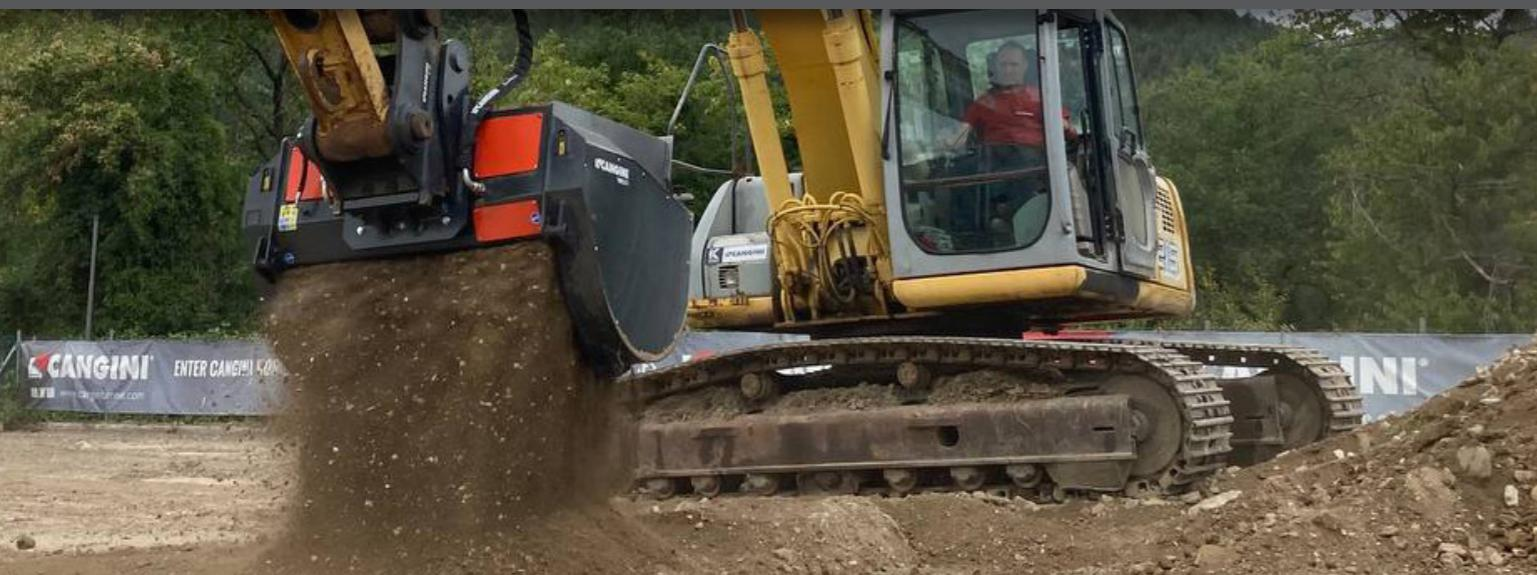
DER SIEBLÖFFEL VRC EIGNET SICH ZUM AUSSIEBEN DIVERSER MATERIALIEN BEI ABBRUCH- ODER AUSHUBARBEITEN DIE SIEBBAREN MATERIALSTÄRKEN REICHEN IN DER STANDARDKONFIGURATION VON ≈ 0-25 \*. DAS DESIGN ERLEICHTET DIE MATERIALAUFNAHME UND VERHINDERT EINE VORZEITIGE ABNUTZUNG. DAS SIEBSYSTEM KANN FÜR EINE EINFACHE WARTUNG PROBLEMLOS AUSGETAUSCHT WERDEN; DAS SORTIEREN ERFOLGT MIT HILFE EINER WELLENGRUPPE AUS EXTREM ROBUSTEM, DEREN AUFBAU DIE SIEBFLÄCHE VERGRÖSERT UND DIE PRODUKTIVITÄT OPTIMIERT.
