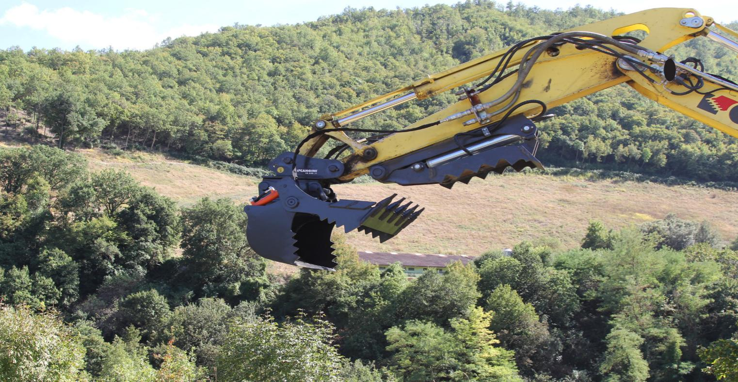
LA CUCHARA 4 EN 1 ES UN EQUIPO MULTIFUNCIONAL CAPAZ DE REALIZAR DIVERSAS FUNCIONES EN LA OBRA. IDEAL PARA ACTIVIDADES DE EXCAVACIÓN, DESCARGA Y CARGA. TAMBIÉN ES ADECUADA PARA OPERACIONES DE NIVELACIÓN Y RELLENO. ADEMÁS, LA CUCHILLA DE DOBLE DENTADO LA HACE EFICAZ PARA AGARRAR DIFERENTES MATERIALES.
