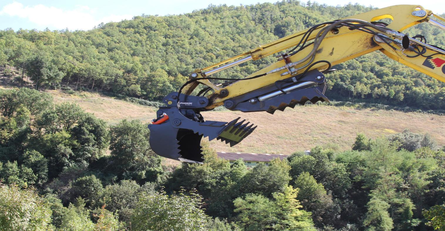
DIE 4-IN-1-SCHAUFEL IST EIN MULTIFUNKTIONALES GERÄT, DAS FÜR VERSCHIEDENE AUFGABEN AUF DER BAUSTELLE EINGESetzt WERDEN KANN. IDEAL FÜR AUSHUB-, ABLADE- UND LADETÄTIGKEITEN. AUCH FÜR NIVELLIERUNGS- UND VERFÜLLUNGSARBEITEN GEEIGNET. DIE DOPPELT GEZAHNTEN SCHAUFEL ERMÖGLICHT ZUDER Das GREIFEN VERSCHIEDENER MATERIALIEN.
