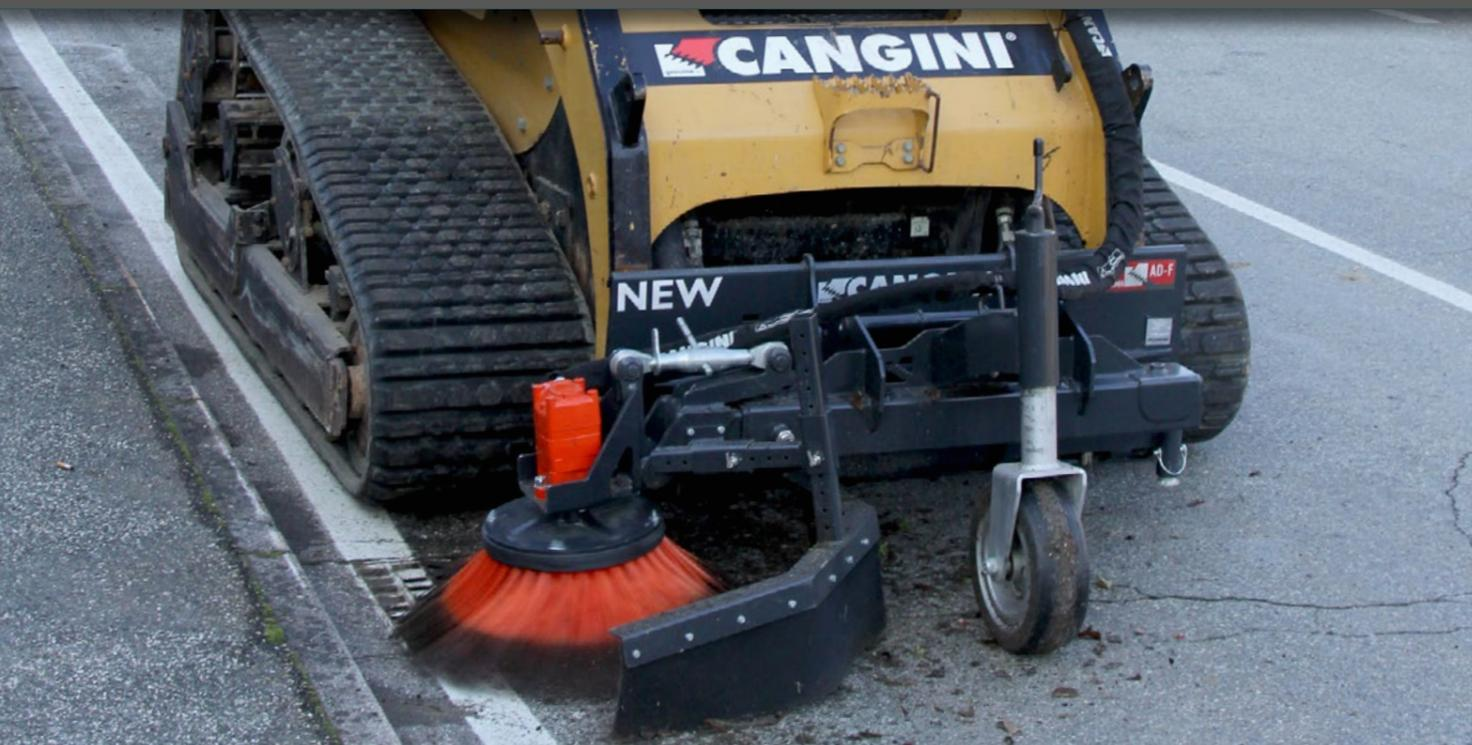
LA SPAZZOLA PER ATTACCO FRONTALE PUÒ ESSERE FACILMENTE MONTATA SIA A DESTRA CHE A SINISTRA, IN MODO DA POTER PULIRE ENTRAMBI I LATI DELLA STRADA. SNODO REGOLABILE E FLOTTANTE LE PERMETTONO DI SEGUIRE L'ANDAMENTO DELLA SUPERFICIE DA PULIRE.
