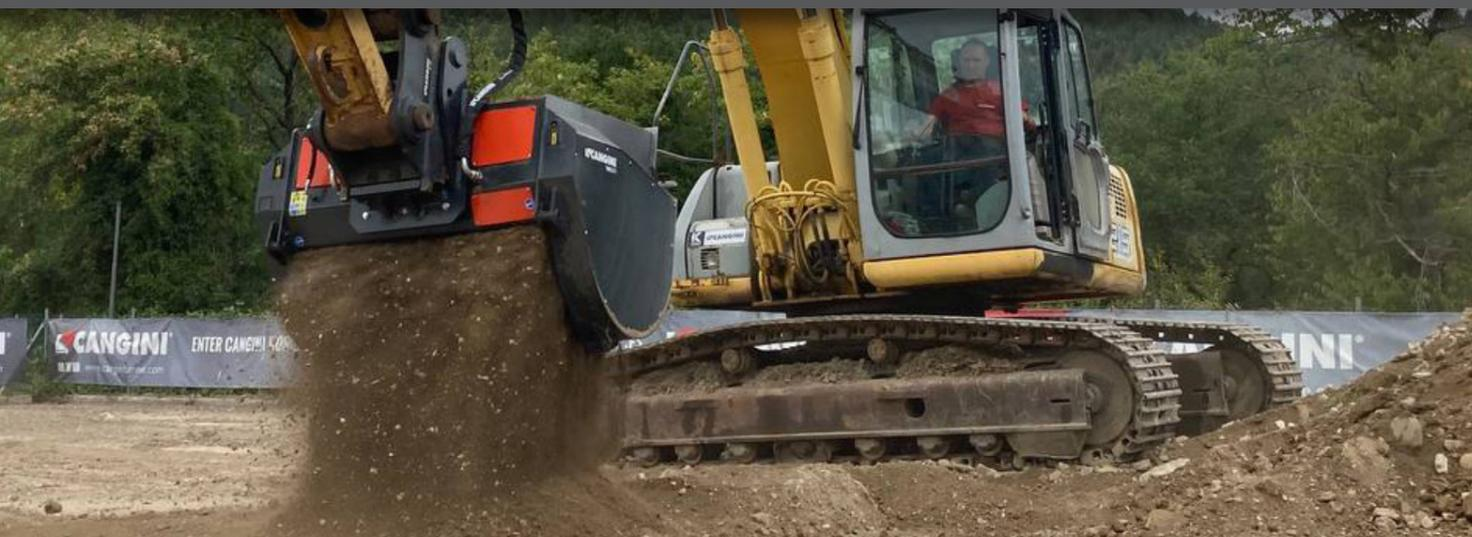
LA BENNA VAGLIATRICE VRC È ADATTA ALLA SELEZIONE DI DIVERSI MATERIALI DERIVATI DA DEMOLIZIONI O SCAVI. LO SPESSORE DEL MATERIALE DA VAGLIARE VA DA ≈ 0-25 \* IN CONFIGURAZIONE STANDARD. IL SUO DESIGN È PENSATO PER FACILITARE IL CARICO DEL MATERIALE ED EVITARE USURE. IL SISTEMA DI VAGLIO È FACILMENTE SOSTITUIBILE PER UNA SEMPLICE MANUTENZIONE. LA SELEZIONE AVVIENE ATTRAVERSO UN GRUPPO ALBERI DISTRIBUITO PER UNA MAGGIORE PRODUTTIVITÀ.
