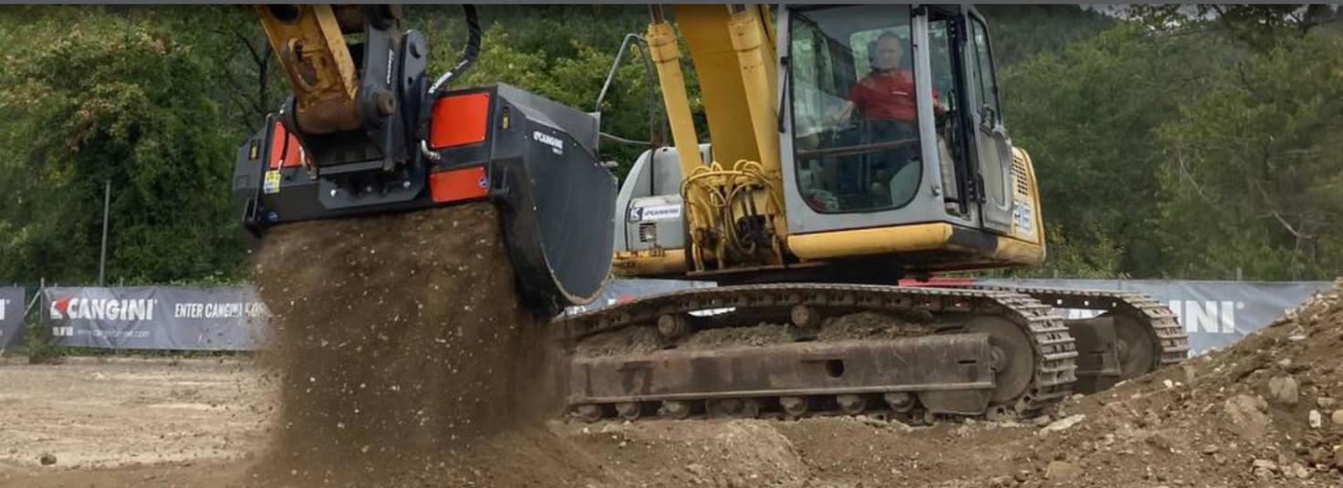
DER SIEBLÖFFEL VRC EIGNET SICH ZUM AUSSIEBEN DIVERSE MATERIALIEN BEI ABRUCH- ODER AUSHUBARBEITEN DIE SIEBBAREN MATERIALSTÄRKEN REICHEN IN DER STANDARDKONFIGURATION VON ≈ 0-25 \*. DAS DESIGN ERLEICHTERT DIE MATERIALAUFNAHME UND VERHINDERT EINE VORZEITIGE ABNUTZUNG. DAS SIEBSYSTEM KANN FÜR EINE EINFACHE WARTUNG PROBLEMLOS AUSGETAUSCHT WERDEN; DAS SORTIEREN ERFOLGT MIT HILFE EINER WELLENGRUPPE AUS EXTREM ROBUSTEM, DEREN AUFBAU DIE SIEBLÄCHE VERGRÖßERT UND DIE PRODUKTIVITÄT OPTIMIERT.
