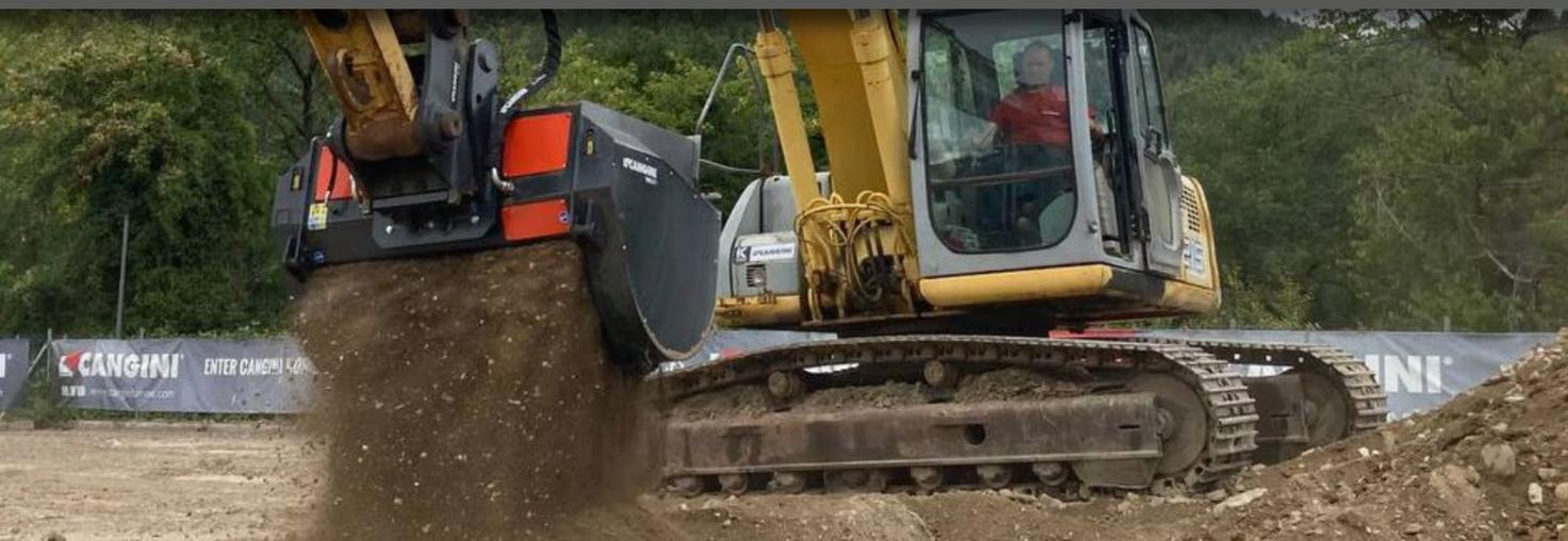
LA BENNA VAGLIATRICE VRC È ADATTA ALLA SELEZIONE DI DIVERSI MATERIALI DERIVATI DA DEMOLIZIONI O SCAVI. LO SPESSORE DEL MATERIALE DA VAGLIARE VA DA 0-35MM IN CONFIGURAZIONE STANDARD. IL SUO DESIGN È PENSATO PER FACILITARE IL CARICO DEL MATERIALE ED EVITARE USURE. IL SISTEMA DI VAGLIO È FACILMENTE SOSTITUIBILE PER UNA SEMPLICE MANUTENZIONE. LA SELEZIONE AVVIENE ATTRAVERSO UN GRUPPO ALBERI DISTRIBUITO PER UNA MAGGIORE PRODUTTIVITÀ.
