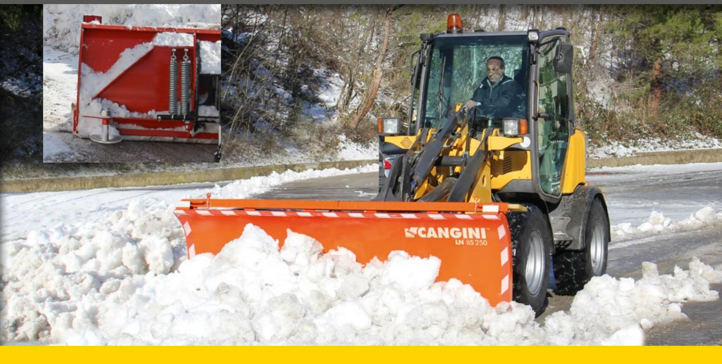
DOTATA DI VALVOLE ANTIURTO, ANGOLAZIONE IDRAULICA  $\pm 30^\circ$ , SISTEMA DI AUTOLIVELLAMENTO AL MANTO STRADALE  $\pm 10^\circ$  E PIEDINI DI APPOGGIO REGOLABILI. IN CASO DI URTO È PREVISTO IL RIBALTAMENTO DELL'INTERO VERSOIO CON RITORNO A MOLLE.
