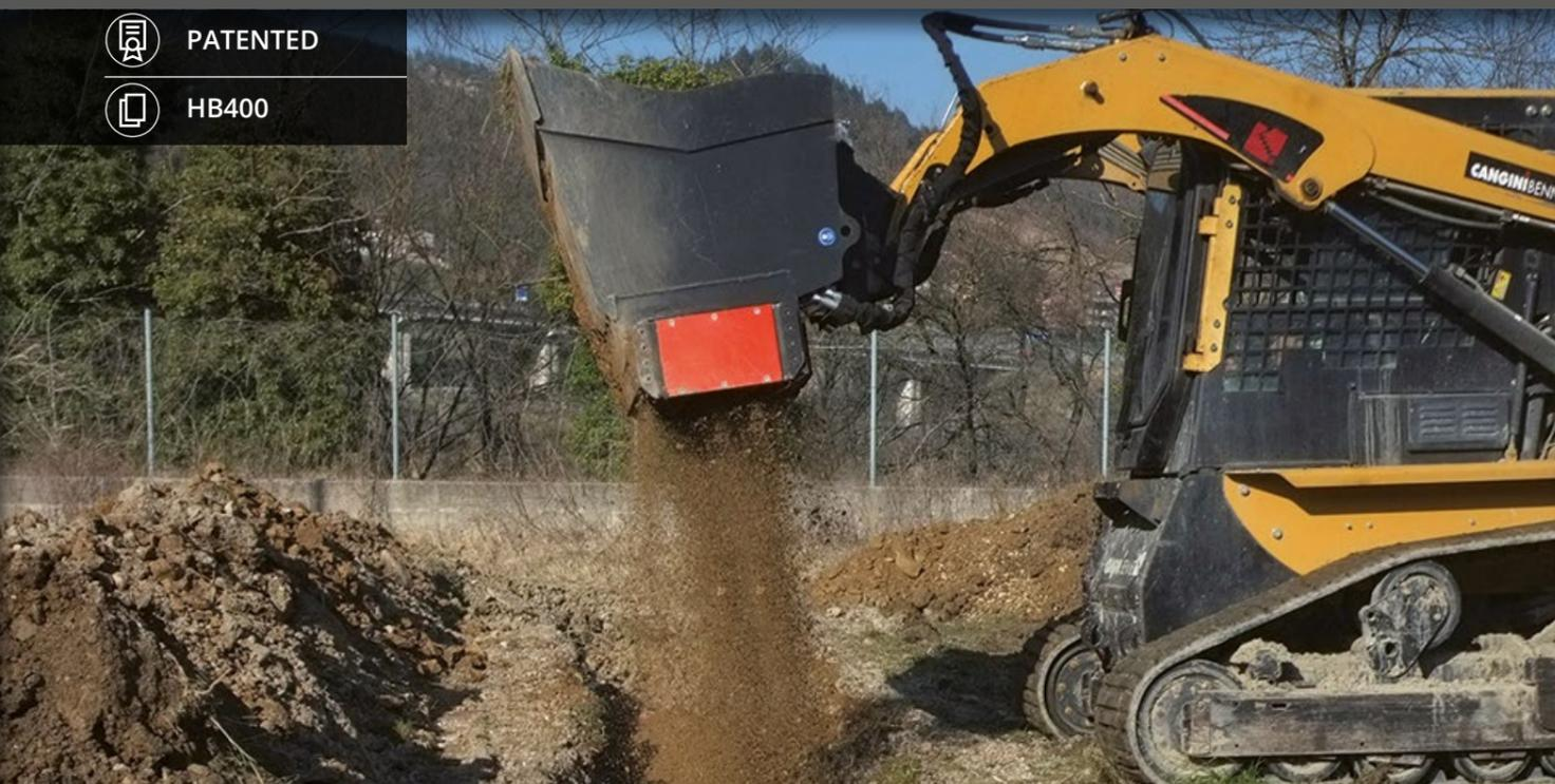
ADATTA ALLA SELEZIONE DI MATERIALI DERIVATI DA DEMOLIZIONI, SCAVI E MOVIMENTO TERRA IN GENERALE. ADATTA ANCHE ALLA MISCELAZIONE DI TERRENI CON TORBA. LA SELEZIONE AVVIENE ATTRAVERSO UN GRUPPO VAGLIO IDRAULICO A COLTELLI ROTANTI IN HB400. LO SPESSORE DEL MATERIALE SELEZIONATO PUÒ VARIARE DA 0-20 MM FINO A 0-35 MM IN CONFIGURAZIONE STANDARD.
