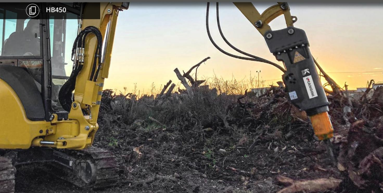
IL MARTELLI DEMOLITORE IDRAULICO SERIE C.B È DISPONIBILE IN 9 MODELLI PER ESCAVATORI CON PESO OPERATIVO DA 0,5 A 12,5 TON. LA SUA STRUTTURA È REALIZZATA CON SCOCCA A INVOLUCRO PENSATA PER RIDURRE AL MINIMO I LIVELLI SONORI EMESSI DAL MARTELLI. IL SISTEMA È SVILUPPATO PER RECUPERARE ENERGIA INERZIALE DELL'AZOTO CON CONSEGUENTE AUMENTO DI POTENZA. IL DESIGN DEL PRODOTTO FAVORISCE UNA MIGLIORE VISIBILITÀ DURANTE LE FASI OPERATIVE.
