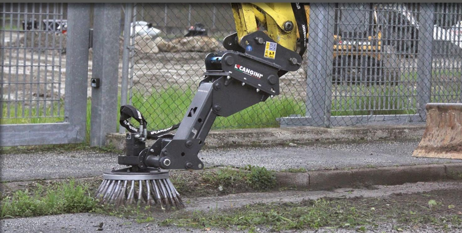
CETTE BROSE, POUR PELLETEUSE, DOTÉE D'ÉLÉMENTS EN ACIER, EST ADAPTÉE AU NETTOYAGE DE BORDURES, TROTTOIRS ET ACCOTEMENTS DES ROUES. LE SYSTÈME FLOTTANT ET LE JOINT, DE SÉRIE, PERMETTENT À LA BROSE DE SUIVRE LES SURFACES. LES DEUX SYSTÈMES D'ARTICULATION PEUVENT ÊTRE BLOQUÉS EN POSITION FIXE SELON LES EXIGENCES DE L'UTILISATEUR. EN ADOPTANT LA BROSE EN PPL ON PEUT TRAITER LES SURFACES LES PLUS DÉLICATES OÙ LE DÉSHÉRBAGE N'EST PAS NÉCESSAIRE.
