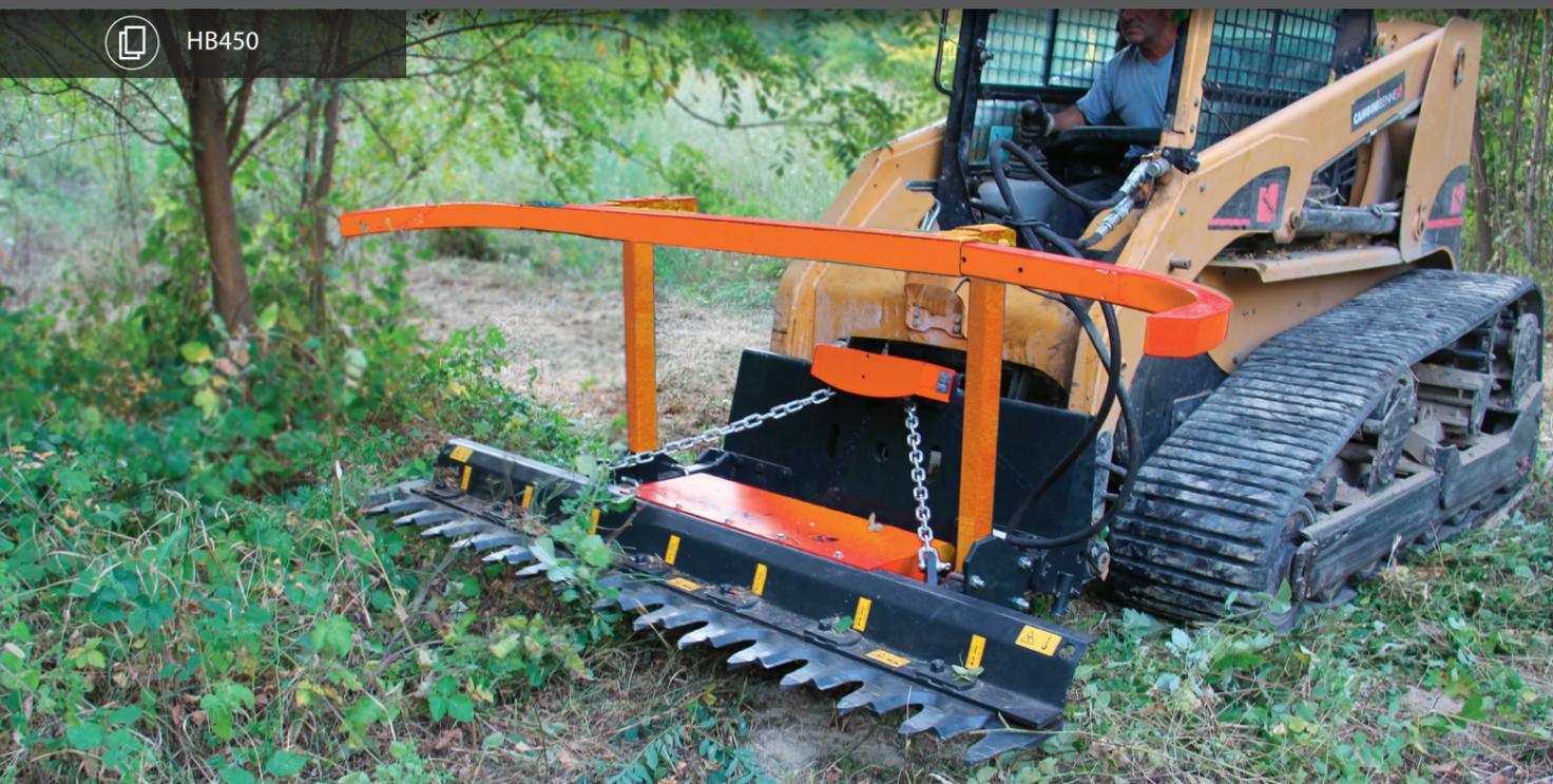
EL CABEZAL CORTADOR DE RAMAS SHARP-CUT SE UTILIZA PARA LA PODA DE RAMAS DE 0 A 100 MM. CON SU CORTE NETO Y PRECISO, NO ARRUINA LA PLANTA NI ARRANCA LA RAMA. LAS CUCHILLAS DE LA SIERRAS SON DE HB450, QUE GARANTIZA UNA GRAN DURACIÓN Y RESISTENCIA.
