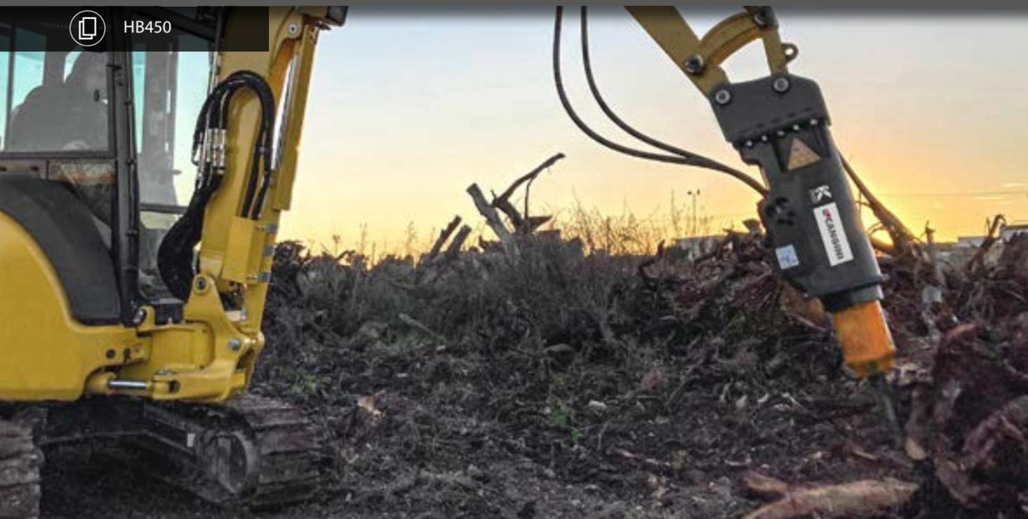
DER HYDRAULISCHE ABBRUCHHAMMER SERIE CB KANN IN 9 MODELLEN FÜR BAGGER MIT EINEM BETRIEBSGEWICHT VON 0,5 BIS 12,5 TONNE GELIEFERT WERDEN. DAS GEHÄUSE IST SO AUSGEFÜHRT, DASS DER GERÄUSCHPEGEL AUF EIN MINIMUM REDUZIERT WIRD. DIE OPTIMIERTE STICKSTOFFTECHNOLOGIE MIT ENERGIERÜCKGEWINNUNG SORGT FÜR EINEN AUTOMATISCHEN ANSTIEG DER PRODUKTIVITÄT. DAS INNOVATIVE PRODUKTDESIGN GEWÄHRLEISTET EINE OPTIMALE SICHT BEIM ARBEITEN.
