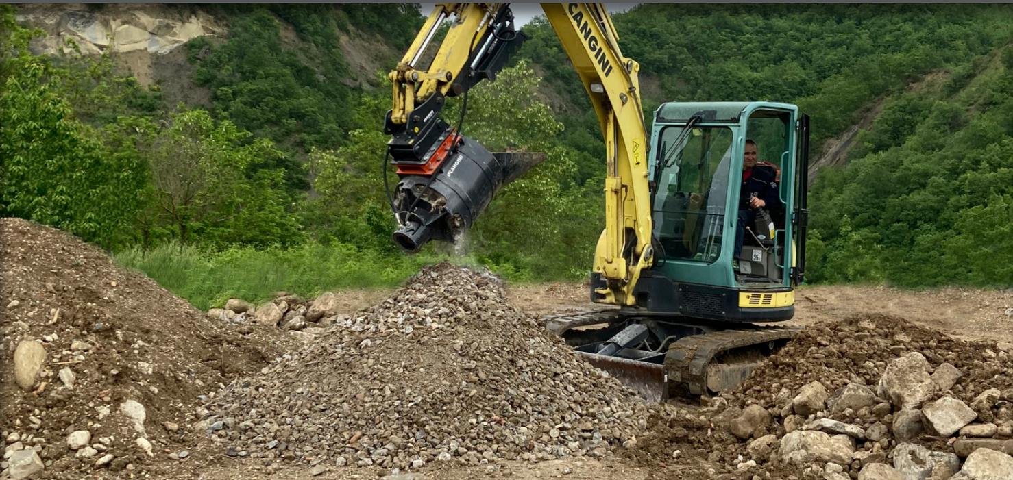
LA CUCHARA TRITURADORA DC FACILITA EL REPROCESADO Y RECICLAJE DE ESCOMBROS Y RESIDUOS DE CONSTRUCCIÓN DE PEQUEÑO VOLUMEN PARA CONVERTIRLOS EN ÁRIDOS APROVECHABLES. PERMITE TRITURAR HASTA UN TAMAÑO APROXIMADO DE 40-70 MM. ES IDEAL PARA APLICACIONES COMO CIMENTACIÓN, PAVIMENTACIÓN DE TALUDES Y PATIOS, PAISAJISMO, CARRETERAS O COMO CAPA BASE BAJO HORMIGÓN VERTIDO.
