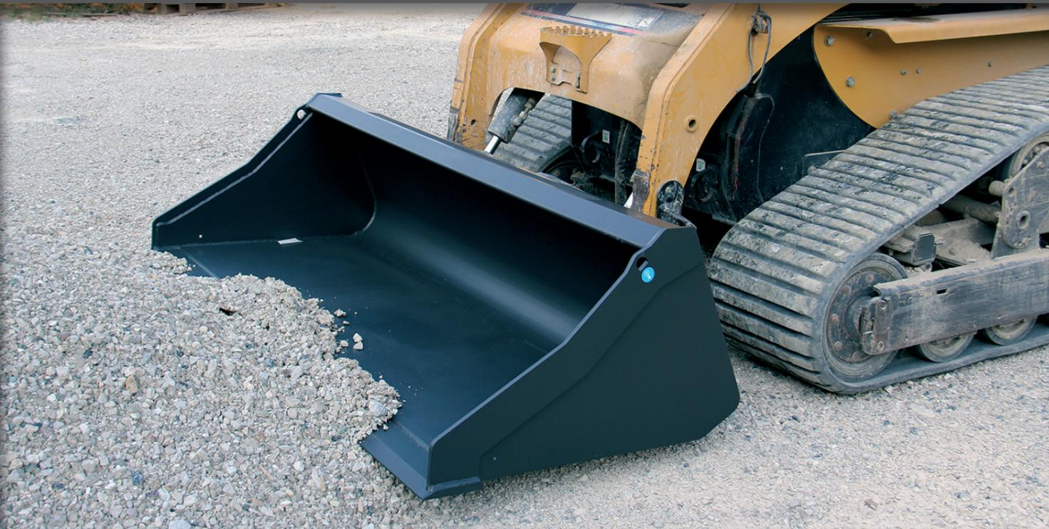
DIE FRONTSCHAUFEL DES KOMPAKTLADERS BIETET EINE OPTIMALE LADEKAPAZITÄT DANK IHRES PROFILS, DAS FÜR EINE BESSERE BODENAUFSTANDSFLÄCHE AUSGELEGT IST. IHRE FORM ERMÖGLICHT ES, DÜNNE UND KÖRNIGE MATERIALIEN IM INNEREN ZU HALTEN, UM MATERIALVERLUSTE WÄHREND DES TRANSPORTS ZU VERMEIDEN. SIE IST DIE IDEALE SCHAUFEL FÜR DAS BE- UND ENTLADEN VERSCHIEDENER MATERIALIEN. DIE ROBUSTE BAUART DES LEVELMAX GEWÄHRLEISTET EINE LANGE LEBENSDAUER DES GERÄTS.
