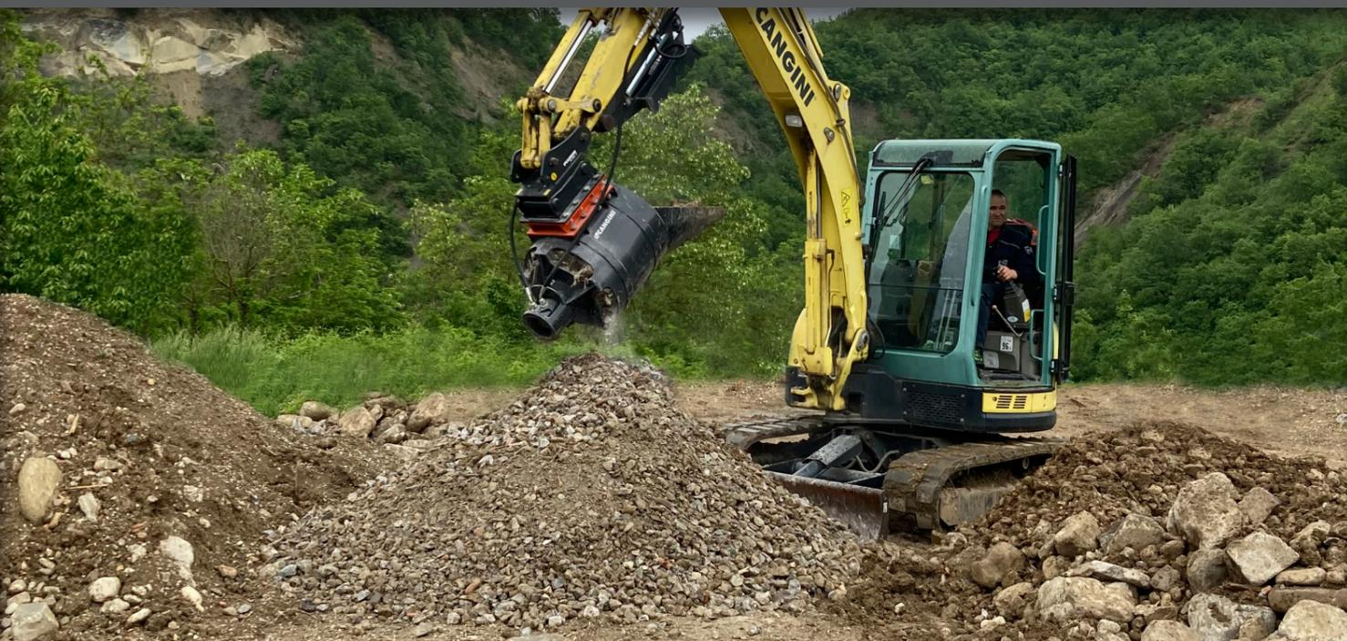
LA BENNA FRANTUMATRICE DC PERMETTE DI RILAVORARE E RICICLARE IN MODO SEMPLICE MACERIE E DETRITI EDILI DI PICCOLO VOLUME, TRASFORMANDOLI IN AGGREGATI UTILIZZABILI. CONSENTE UNA FRANTUMAZIONE FINO A UNA DIMENSIONE DI CIRCA 40-70 MM. È IDEALE PER APPLICAZIONI QUALI: POSA DI FONDAMENTA, PAVIMENTAZIONE DI PISTE E PIAZZALI, PROGETTAZIONE PAESAGGISTICA, STRADE O COME STRATO DI BASE SOTTO IL CALCESTRUZZO VERSATO.
