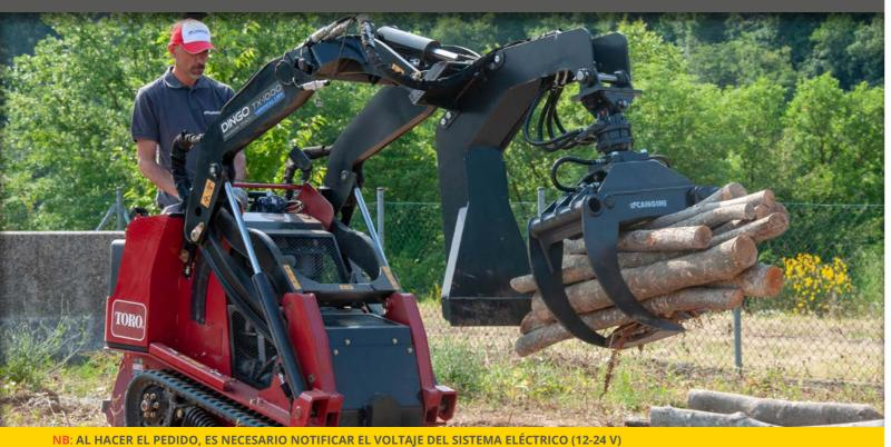
LA PINZA PARA LEÑA PUEDE SER EQUIPADA CON ROTACIÓN HIDRÁULICA A 360° CON ROTADOR EMBRIDADO, LAS PARTES SUJETAS A MAYOR DESGASTE ESTÁN FABRICADAS EN DOMEX700.LA VERSIÓN ESTÁNDAR TIENE DE UNA VÁLVULA DE BLOQUEO EN EL CILINDRO DE CIERRE
