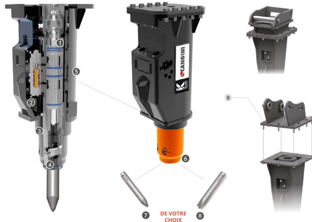
LE MARTEAU-PIQUEUR HYDRAULIQUE SÉRIE C.B. EST DISPONIBLE EN 9 MODÈLES POUR DES PELLES D'UN POIDS OPÉRATIONNEL DE 0,5 À 12,5 TONNES. SA STRUCTURE EST CONSTITUÉE D'UNE ENVELOPPE CONÇUE POUR MINIMISER LES NIVEAUX SONORES ÉMIS PAR LE MARTEAU. LE SYSTÈME EST DÉVELOPPÉ POUR RÉCUPÉRER DE L'ÉNERGIE INERTIELLE DE L'AZOTE, CE QUI PERMET D'AUGMENTER LA PUISSANCE. LA CONCEPTION DU PRODUIT FAVORISE UNE MEILLEURE VISIBILITÉ PENDANT LE FONCTIONNEMENT.
