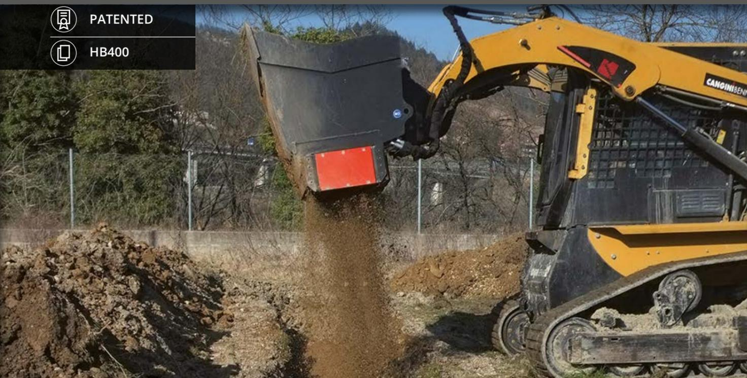
ADAPTÉ À LA SÉLECTION DE DÉCHETS DE TRAVAUX DE DÉMOLITION, CONCASSAGE OU TERRASSEMENT, ET AU MALAXAGE DE TERRE ET TOURBE GRÂCE AU CRIBLEUR HYDRAULIQUE DOTÉ DE COUTEAUX ROTATIFS EN HB400. EN CONFIGURATION STANDARD, LA TAILLE DU MATÉRIAU PEUT ÊTRE COMPRISE ENTRE 0 ET 20 ET ENTRE 0 ET 35.
