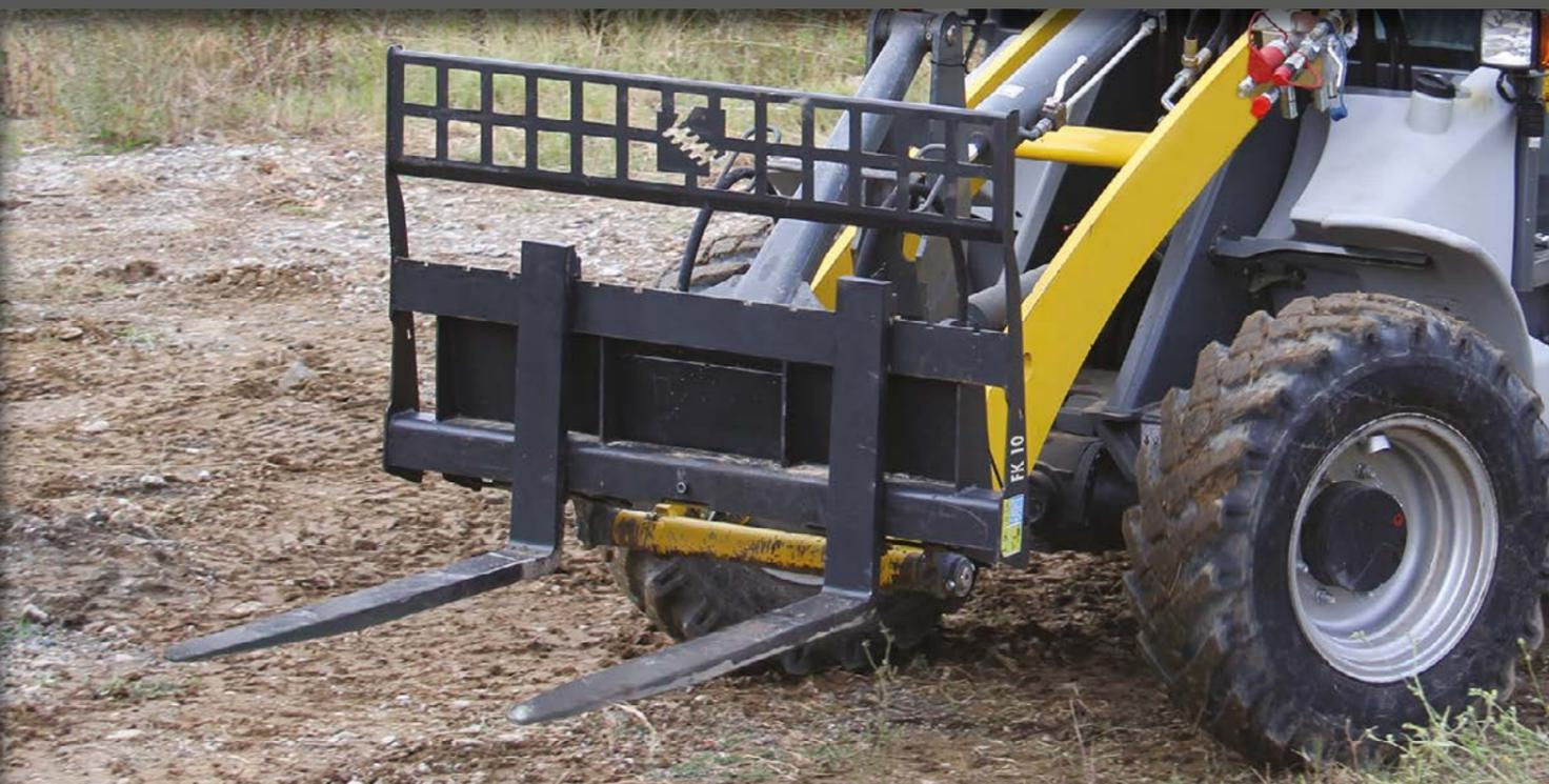
LE TABLIER FRONTAL PERMET L'ACCROCHAGE À CHARGEUSES COMPACTES, CHARGEUSES SUR PNEUS, TÉLESCOPIQUES ET TRACTOPELLES. EQUIPÉ D'UNE PROTECTION DE SÉCURITÉ CONTRE LE RENVERSEMENT DES CHARGES PENDANT L'UTILISATION.
