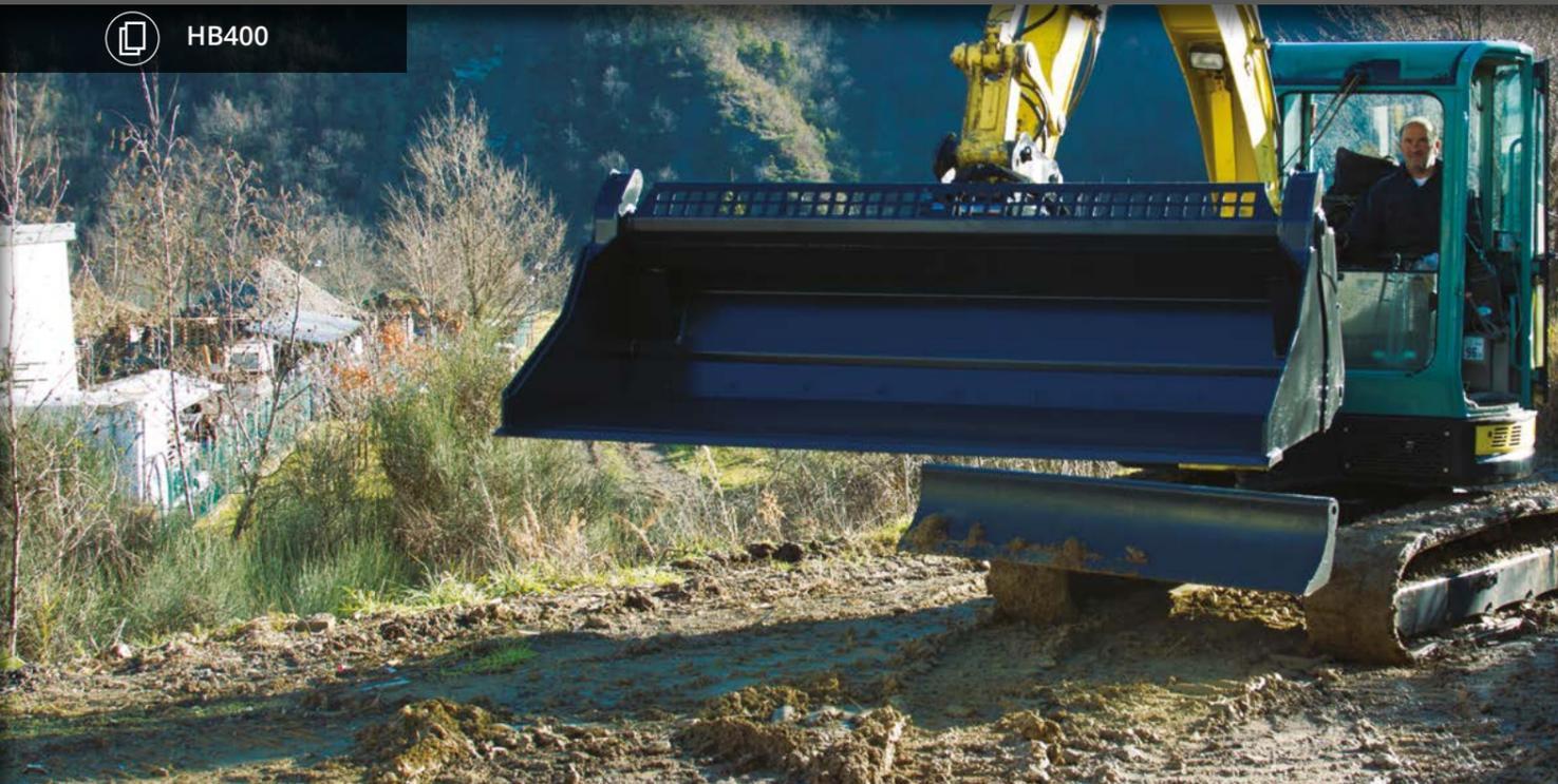
CE GODET EST APPROPRIÉ POUR LES TRAVAUX DE CHARGEMENT, DÉCHARGEMENT ET MANIPULATION. L'OUVERTURE HYDRAULIQUE LUI PERMET AUSSI DE PRENDRE DES OBJETS, DE DOSER LE DÉCHARGEMENT DE MATÉRIAUX ET DE NIVELER LE SOL.
