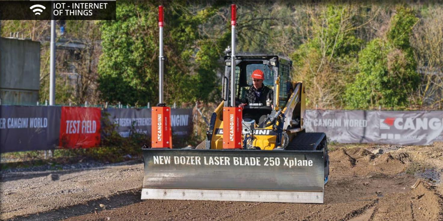
TOUS LES MODÈLES DE LA LAME DOZER LASER XPLANE SONT ÉQUIPÉS D'UN SYSTÈME DE CONNEXION AVEC LE CLOUD CANGINI GRÂCE À LA TECHNOLOGIE IOT (INTERNET OF THINGS).
