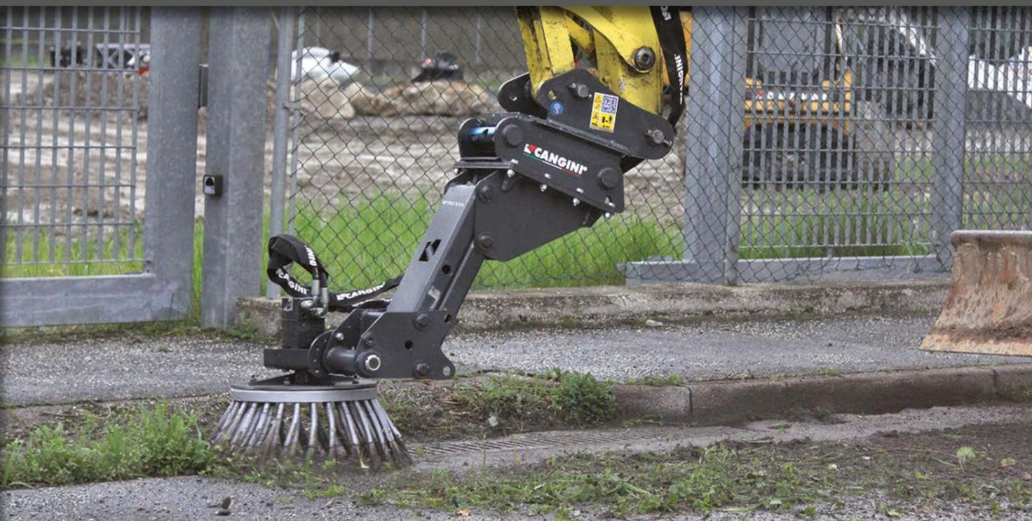
CETTE BROSSSE, POUR PELLETEUSE, DOTÉE D'ÉLÉMENTS EN ACIER, EST ADAPTÉE AU NETTOYAGE DE BORDURES, TROTTOIRS ET ACCOTEMENTS DES ROUES. LE SYSTÈME FLOTTANT ET LE JOINT, DE SÉRIE, PERMETTENT À LA BROSSSE DE SUIVRE LES SURFACES. LES DEUX SYSTÈMES D'ARTICULATION PEUVENT ÊTRE BLOQUÉS EN POSITION FIXE SELON LES EXIGENCES DE L'UTILISATEUR. EN ADOPTANT LA BROSSSE EN PPL ON PEUT TRAITER LES SURFACES LES PLUS DÉLICATES OÙ LE DÉSHÉRBAGE N'EST PAS NÉCESSAIRE.
