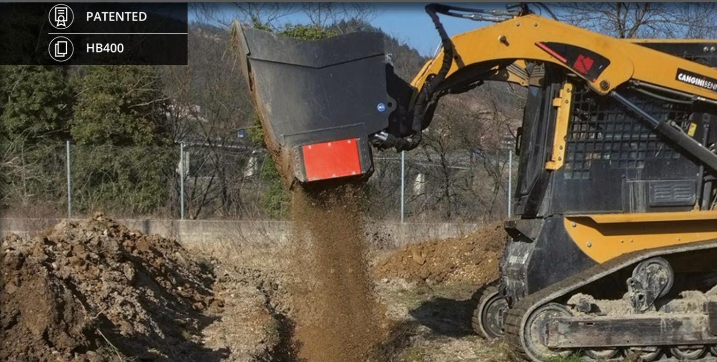
FÜR RAD-, KOMPAKT-, BAGGERLADER UND, TELESKOPLADER. ZUM SIEBEN VON ABRUCH- UND AUSHUBMATERIAL ODER ERDE, ABER AUCH ZUM VERMISCHEN VON ERDE UND TORF. DIE HYDRAULISCH ANGETRIEBENEN SIEBWELLEN SIND AUS HB 400 GEFERTIGT. STANDARDSIEBWEITEN 0-20 MM UND 0-35 MM.
