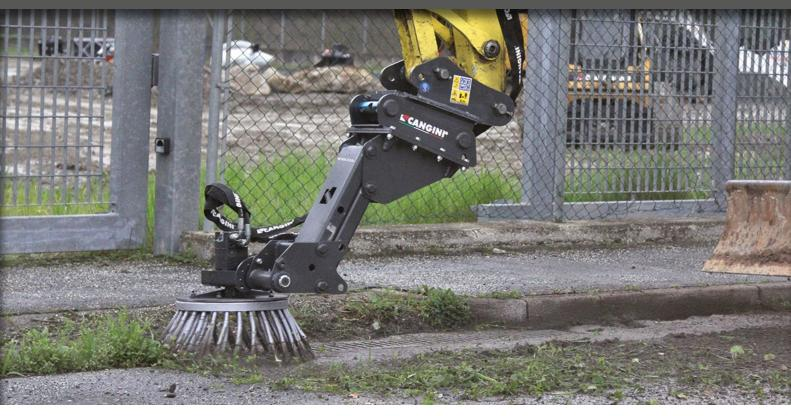
ESTE CEPILLO SE APLICA EN LA EXCAVADORA Y PRESENTA CERDAS DE ACERO, POR LO QUE ES IDEAL PARA LA ESCARDA DE BORDILLOS, ACERAS, BANQUINAS, ASFALTO, ETC. EL SISTEMA FLOTANTE Y LA ARTICULACIÓN DEL CABEZAL INCLUIDOS EN EL EQUIPAMIENTO PERMITEN LA ADAPTACIÓN DEL CEPILLO A LAS SUPERFICIES. LOS DOS SISTEMAS DE ARTICULACIÓN PUEDEN BLOQUEARSE EN UNA POSICIÓN DETERMINADA SEGÚN LAS NECESIDADES DEL USUARIO. EL CEPILLO DE PPL PERMITE BARRER SUPERFICIES DELICADAS DONDE NO SE REQUIERA LA OPERACIÓN DE ESCARDA.
