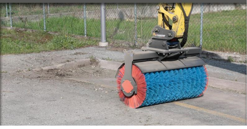
BALAYEUSE POUR PELLETEUSES, INDIQUEÉE POUR LE NETTOYAGE DE SURFACES HORIZONTALES ET VERTICALES ET D'ESPACES QUE LES MACHINES FRONTALES NE PEUVENT PAS REJOINDRE. EQUIPPÉE DE PATINS STABILISATEURS POUR SAUVEGARDER LES BROSSES PENDANT LE POSITIONNEMENT DE L'OUTIL. VANNES RÉGULATRICES DE FLUX ET DE PRESSION DE SÉRIE. LE MOTEUR À TRANSMISSION DIRECTE AVEC DISTRIBUTEUR À DISQUES A ÉTÉ PLACÉ À L'INTÉRIEUR DE L'ARBRE DES BROSSES POUR REDUIRE L'ENCOMBREMENT OPERATIONNEL DE LA BALAYEUSE.
