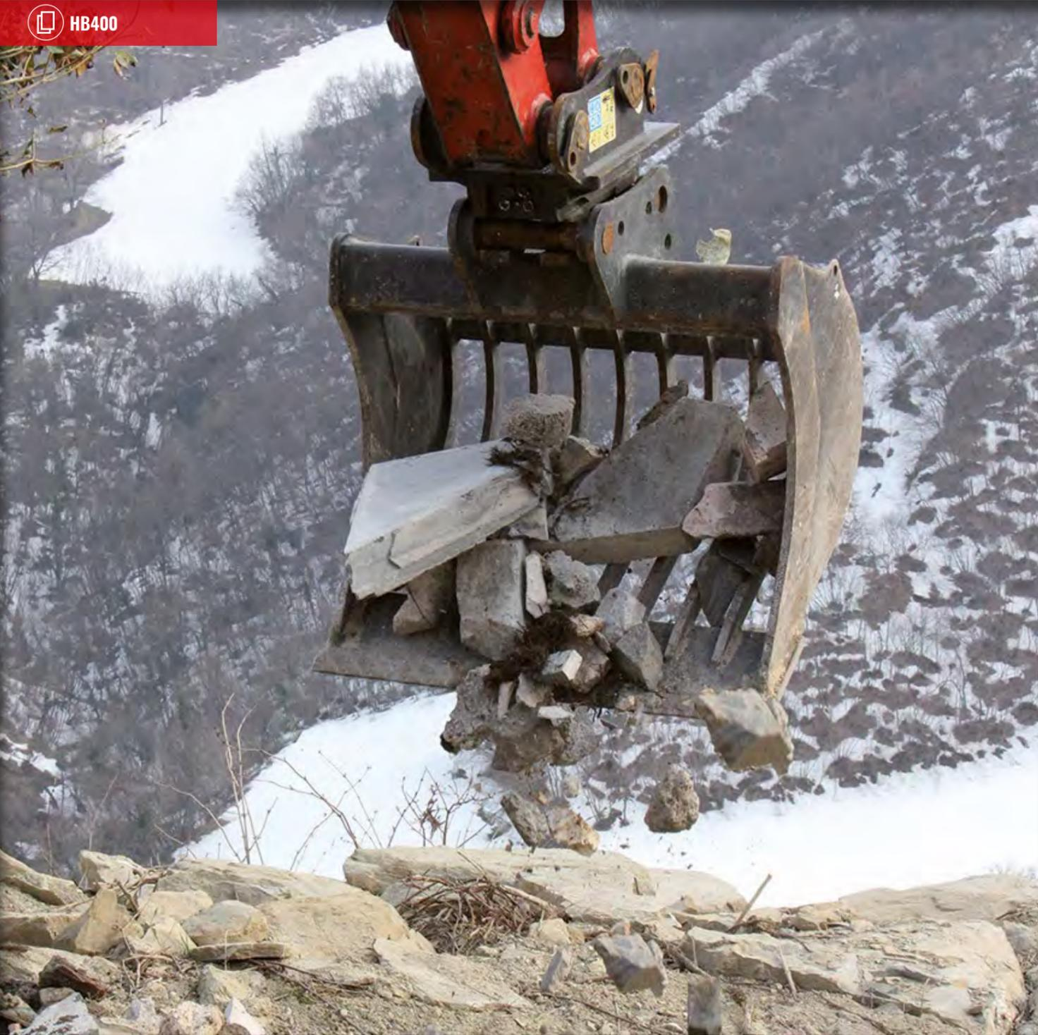
DANK DER LÄNGLICHEN FORM UND DER TIEFEN SEITENWÄNDE IDEAL FÜR LEHMIGE BÖDEN, DA WENIG AUSHUB AN DEN FLANKEN KLEBEN BLEIBT. DER GITTERBODEN EIGNET SICH BESONDERS FÜR EINSÄTZE AUF SEHR FEUCHTEM BZW. NASSEM BODEN UND ERMÖGLICHT AUCH DAS SORTIEREN, TRENNEN UND WIEDERVERWERFEN VON LOSEM MATERIAL. SCHNEIDE AUS 400 HB-STAHL.
