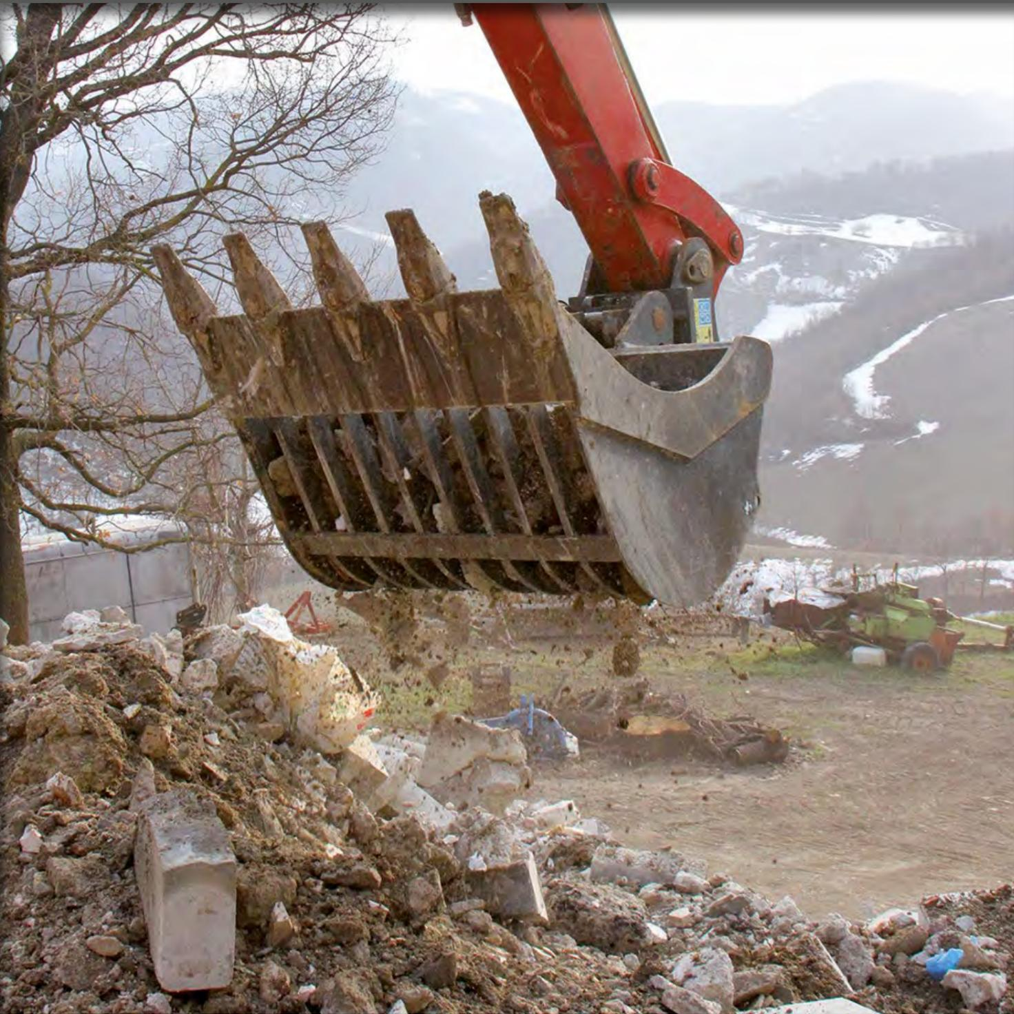
DER GITTERLÖFFEL DIENT ZUM SORTIEREN VON STEINEN USW. KLEINERES MATERIAL, SAND UND ERDE FALLEN BEIM SCHÜTTELN DES AUSLEGERERS DURCH DAS GITTER ZUM BODEN. AUF ANFRAGE KÖNNEN AUCH LÖFFEL MIT ABWEICHENDEN STEGABSTÄNDEN DELIEFERT WERDEN.
