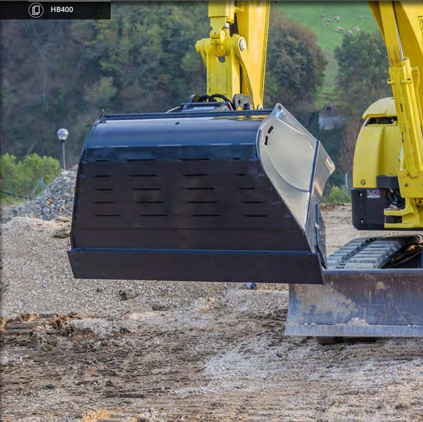
DIESER STARRE LÖFFEL IST IN DEN VERSCHLEISSBEREICHEN VERSTÄRKT. ER VERJÜNGT SICH IN ZWEI STUFEN. IM OBEREN BEREICH IST ER UM 25° SCHMALER, UND DAHER IDEAL GEEIGNET FÜR DEN EINSATZ IN VERBINDUNG MIT EINEM ROTOTWIST. AN DER UNTEREN RÜCKSEITE WIRD UM 8° SCHMALER. DIES ERMÖGLICHT DAS DREHEN DER SCHAUFEL IN DER GRUBE OHNE DIE WÄNDE ZU BESCHÄDIGEN. ER IST MIT VERSTÄRKUNGEN AUS HB 400 IN DEN HAUPTVERSCHLEISSSTELLEN.
