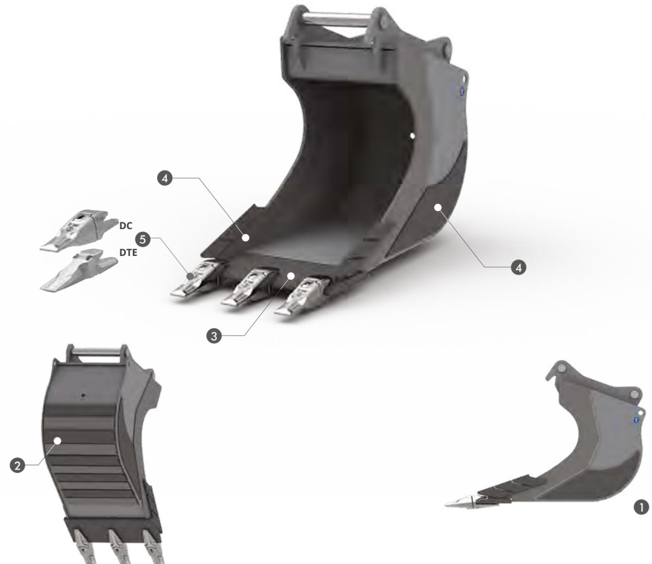
DER FELSLÖFFEL ZEICHNET SICH DURCH SEINE SCHMALE BAUWEISE MIT DEN SEHR TIEFEN SEITENWÄNDEN AUS. ER IST MIT VERSTÄRKUNGEN AUS HB 400 IN DEN HAUPTVERSCHLEISSSTELLEN.
