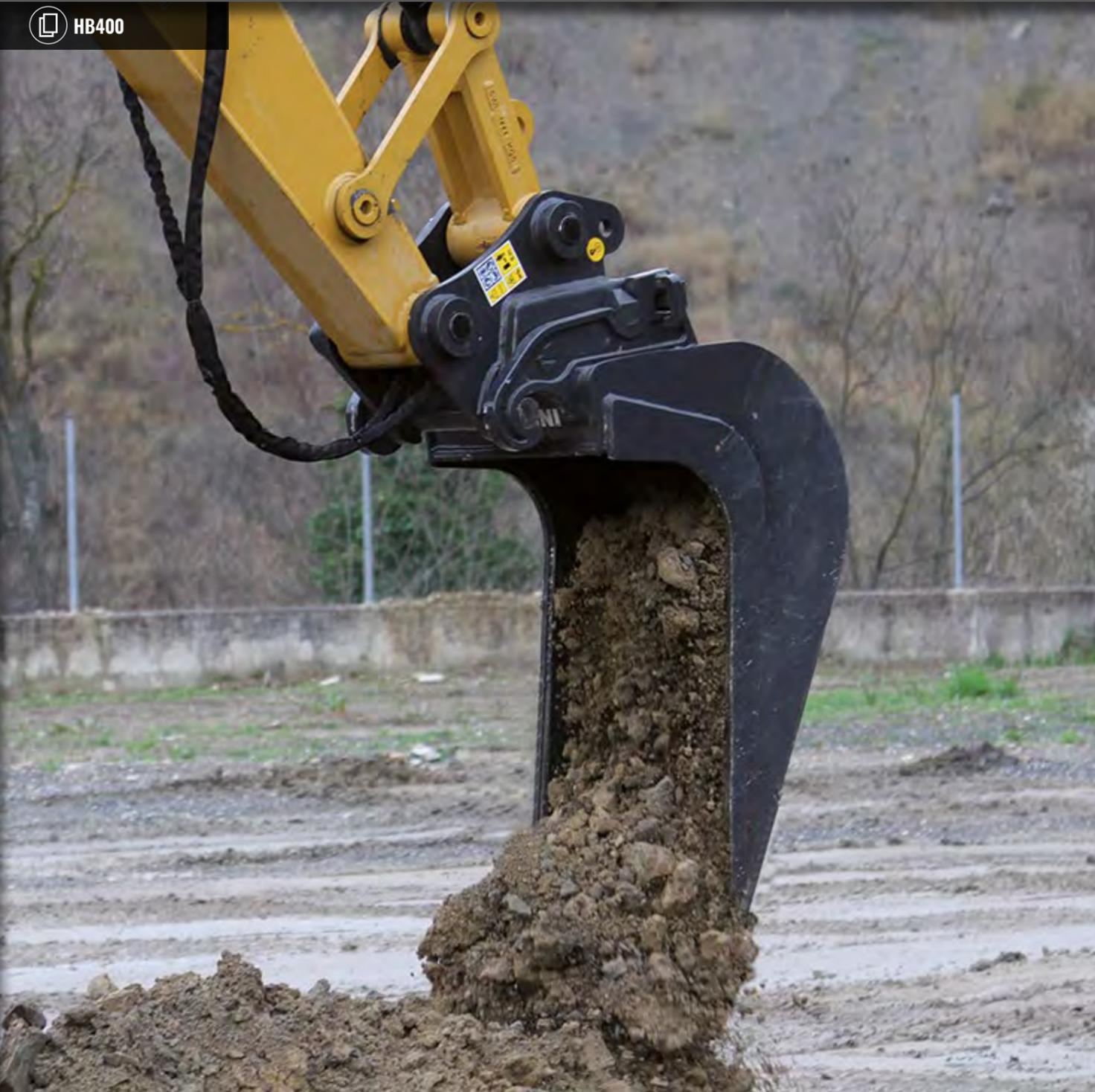
DIESER LEHMLÖFFEL ZEICHNET SICH DURCH SEINE SCHMALE BAUWEISE MIT SEHR TIEFEN SEITENWÄNDEN AUS. ES BLEIBT WENIGER MATERIAL AN DEN SEITENWÄNDEN KLEBEN. DURCH SEINE KOMPAKTEN ABMESSUNGEN EIGNET SICH DER LÖFFEL INSBESONDERE FÜR ARBEITEN IN DER NÄHE VON ROHREN UND KABELN. SCHNEIDE AUS 400HB-STAHL.
