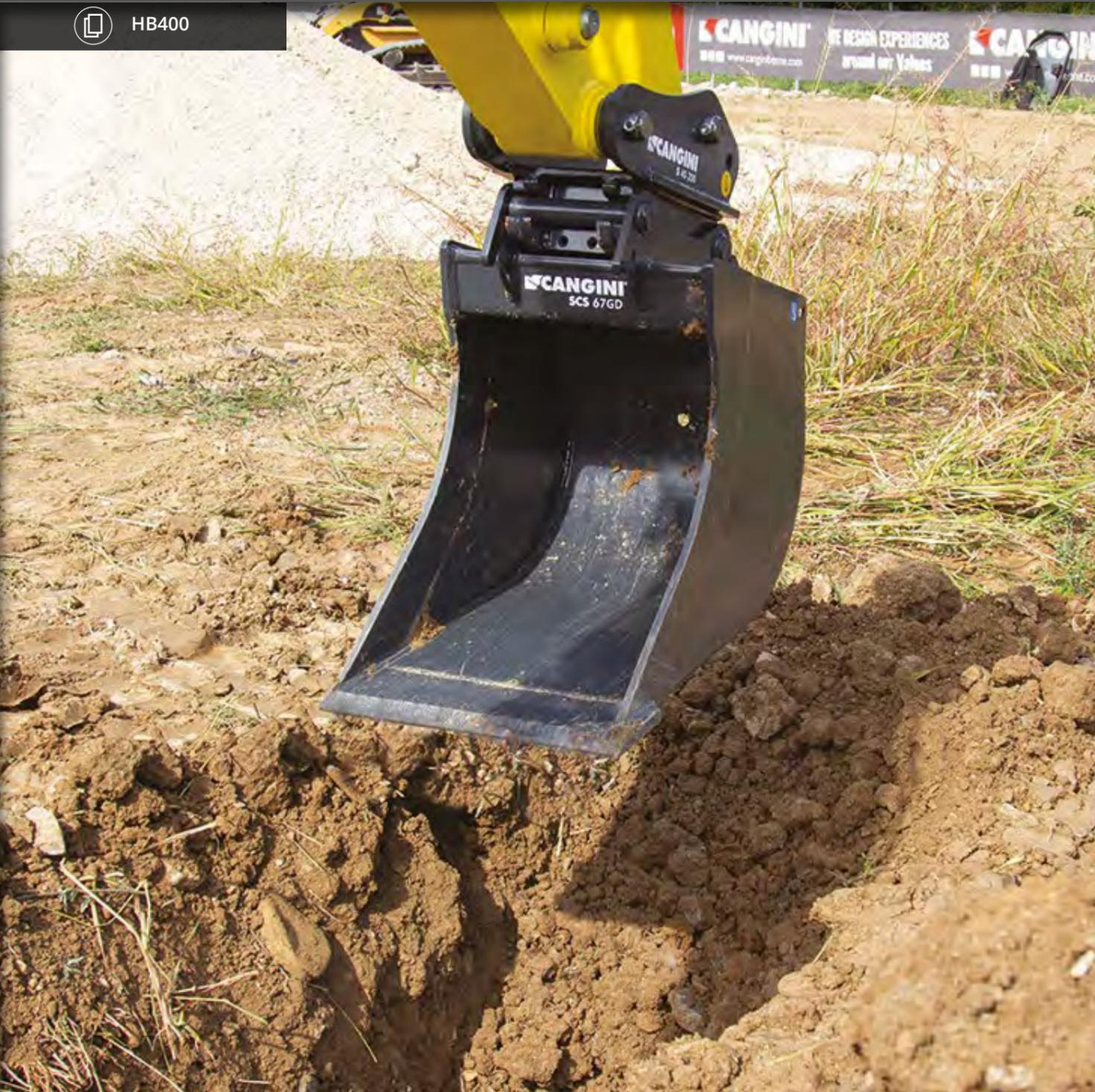
SEINE LANGGEZOGENE FORM VERHINDERT, DASS ERDE AN DEN SEITENWÄNDEN DES LÖFFELS HAFTET, WAS DEN AUSHUB VON TONIGEM UND FEUCHTEM ERDREICH ERLEICHTERT. SCHNEIDE AUS HB400 FÜR HÖHERE VERSCHLEISSFESTIGKEIT.
