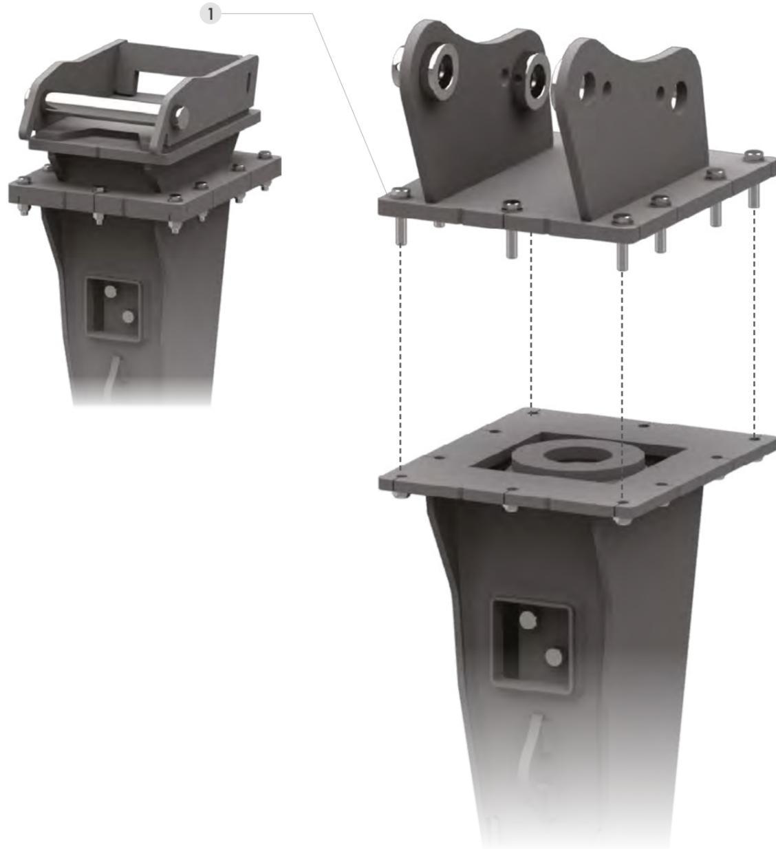
FÜR HÄMMER ALLER MARKEN UND MODELLE ZUM ANBAUEN AN TRÄGERMACHINEN MIT FIXER AUFNAHME ODER SCHNELLWECHSLER.
