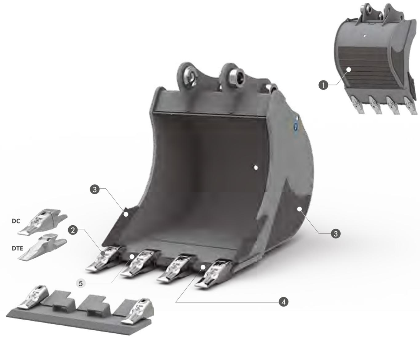
OPTIMALES, KRAFTSPARENDEN EINDRINGVERHALTEN AUF VORWIEGEND FELSIGEN BÖDEN. ROBUST UND EXTREM VERSCHLEISSBESTÄNDIG DANK LÖFFELKÖRPER- UND SEITENVERSTÄRKUNGEN, SEITENSCHNEIDEN UND EINE SCHNEIDKANTEN-SCHUTZVERKLEIDUNG AUS HB400-STAHL.
