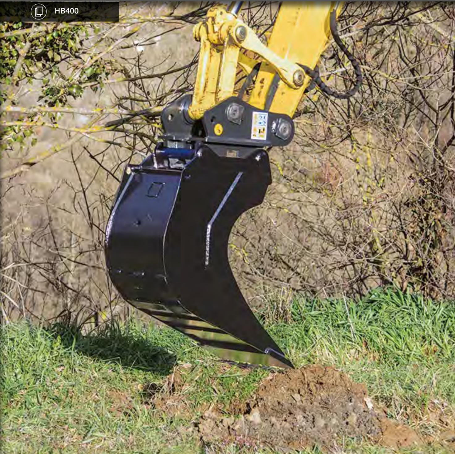
DER FELSLÖFFEL ZEICHNET SICH DURCH SEINE SCHMALE BAUWEISE MIT DEN SEHR TIEFEN SEITENWÄNDEN AUS. SCHNEIDE AUS HB400 FÜR HÖHERE VERSCHLEISSFESTIGKEIT.
