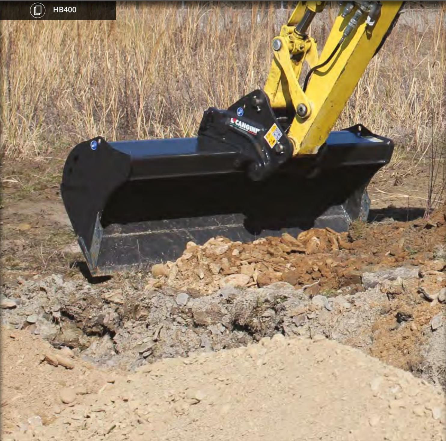
VERSCHLEISSBEANSPRUCHTE TEILE AUS HB400-STAHL, SEITENSCHNEIDEN IN GUSSAUSFÜHRUNG UND WENDBARE, UNTERSCHRAUBSCHNEIDE MACHEN DIESEN LÖFFEL IDEAL FÜR EINSÄTZE BEI STARK VERSCHLEISSENDEN BÖDEN.
