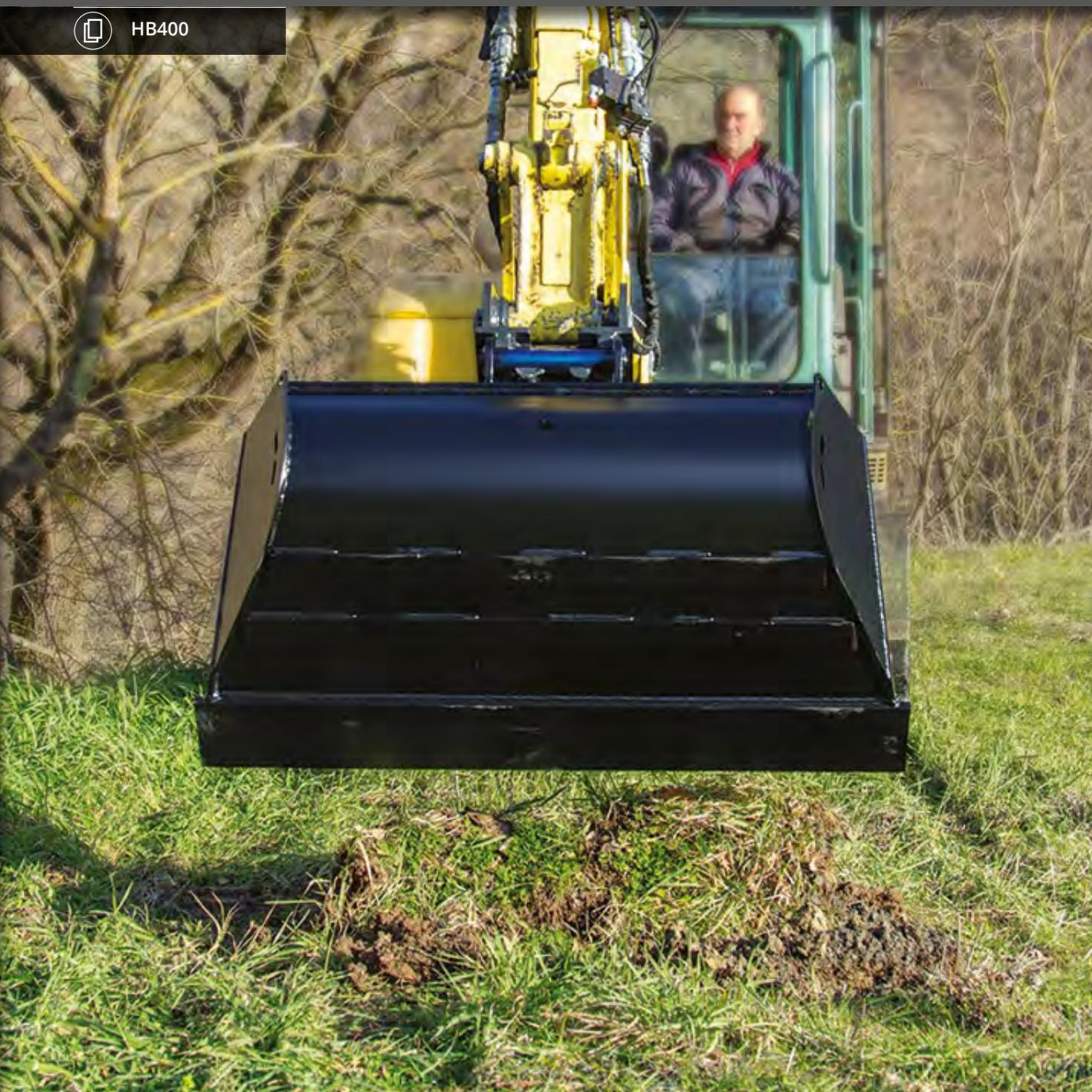
DIESER LÖFFEL VERJÜNGT SICH IN ZWEI STUFEN. IM OBEREN BEREICH IST ER UM 25° SCHMALER, UND DAHER IDEAL GEEIGNET FÜR DEN EINSATZ IN VERBINDUNG MIT EINEM ROTOTWIST. AN DER UNTEREN RÜCKSEITE WIRD UM 8° SCHMALER. DIES ERMÖGLICHT DAS DREHEN DER SCHAUFEL IN DER GRUBE OHNE DIE WÄNDE ZU BESCHÄDIGEN. SCHNEIDE AUS HB400 FÜR HÖHERE VERSCHLEISSFESTIGKEIT.
