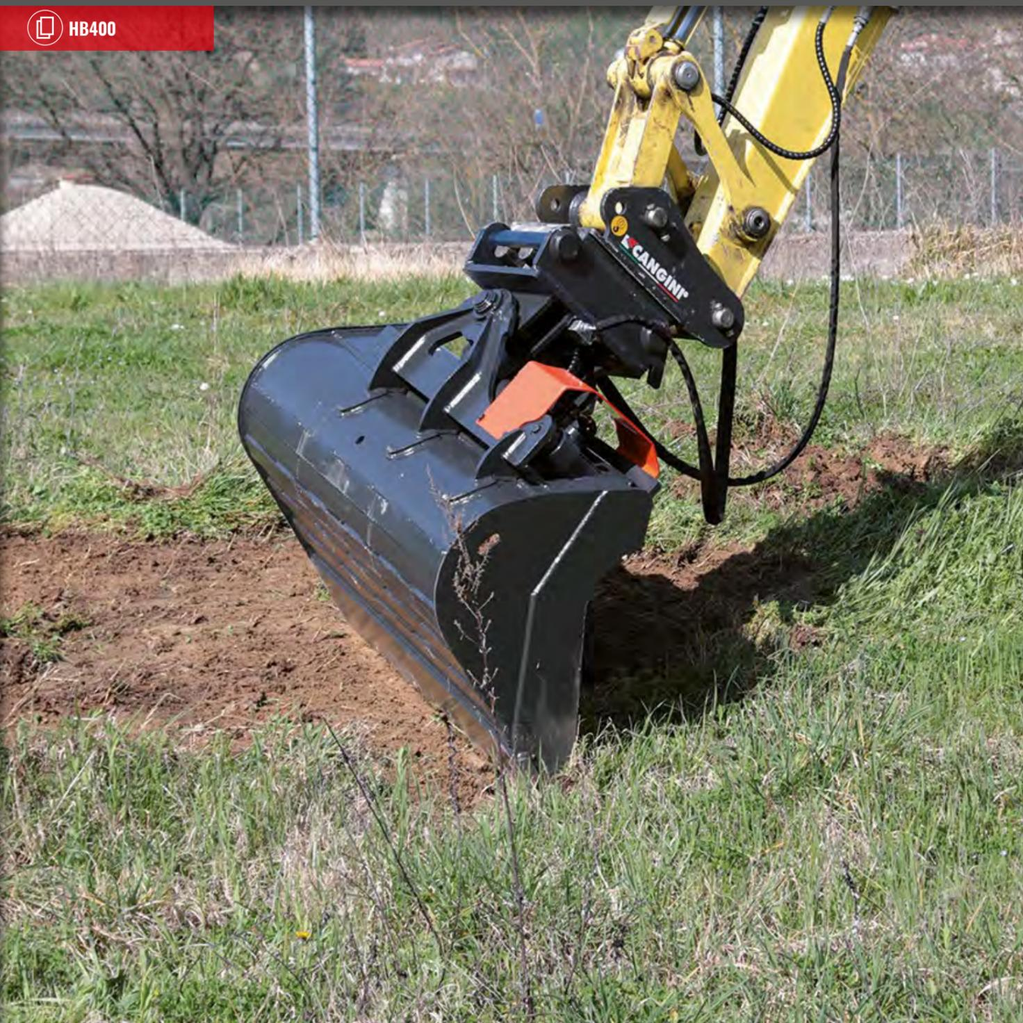
DIESER LÖFFEL EIGNET SICH BESONDERS FÜR DIE FERTIGSTELLUNG UND NIVELLIERUNG. BEIDSEITIG 45° SCHWENKBAR UND SERIENMÄSSIGEM BLOCKVENTIL. SEINE LÄNGLICHE FORM SORGT DAFÜR, DASS BEIM ENTLADEN WENIGER MATERIAL AN DEN SEITENWÄNDEN VERBLEIBT. GEIGNET FÜR LEHMIGE ODER FEUCHTE BÖDEN, ZUM AUSHEBEN UND ANPASSEN VON GRÄBEN, KANÄLEN UND BÖSCHUNGEN. SCHNEIDE AUS 400 HB.
