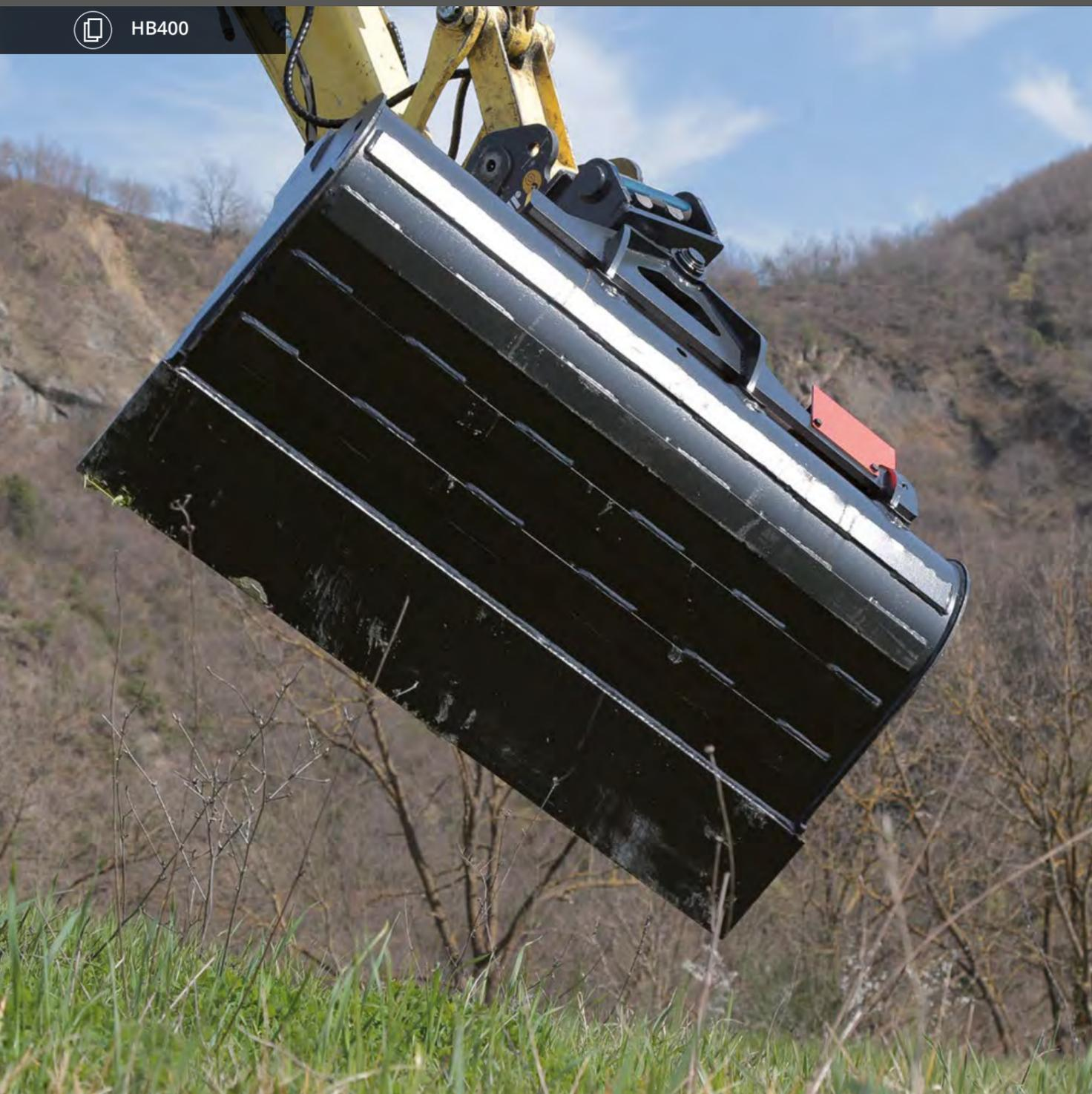
VERSCHLEISSBEANSPRUCHTE TEILE AUS HB400-STAHL, SEITENSCHNEIDEN IN GUSSAUSFÜHRUNG UND EINE WENDBARE, UNTERSCHRAUBSCHNEIDE MACHEN DIESEN LÖFFEL IDEAL FÜR EINSÄTZE AUF EROSIVEN BÖDEN. IDEAL ZUM PROFILIEREN, PLANIEREN UND ABZIEHEN EINES ERDWALLS. BEIDSEITIG 45° SCHWENK- UND DANK SERIENMÄSSIGEM BLOCKVENTIL FESTSTELLBAR.
