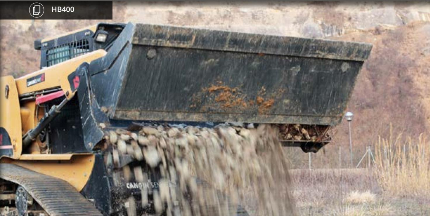
FÜR ERDBEWEGUNGS-, BE- UND ENTLADEARBEITEN. DANK DES HYDRAULISCHEN ÖFFNUNGS- UND SCHLISSMECHANISMUS AUCH ZUM GREIFEN, DOSIERTEN AUFSCHÜTTEN UND PLANIEREN GEEIGNET.
