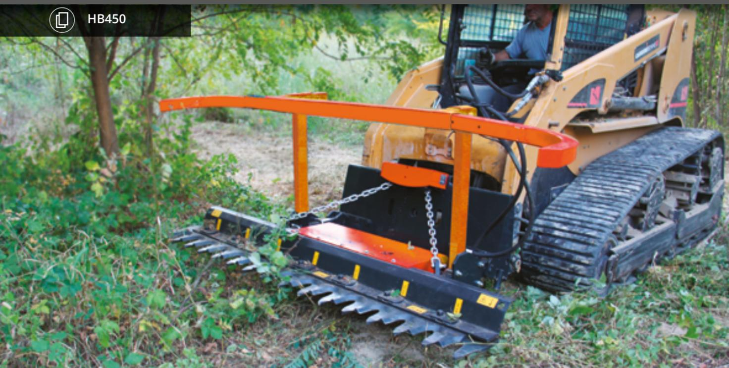
CETTE BARRE SHARP-CUT D'ÉLAGAGE EST ADAPTÉE À LA TAILLE DE BRANCHES JUSQU'À 100 MM. ELLE N'ABÎME PAS LA PLANTE EN EXÉCUTANT UNE TAILLE NETTE ET PRÉCISE QUI NE DÉCHIRE PAS LA BRANCHE. SES LAMES SONT EN HB450, CE QUI ASSURE RÉSISTANCE ET DURETÉ DANS LE TEMPS.
